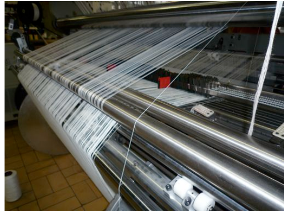
Figuur 2: Dubbel strijkboomsysteem bij gebruik van tweelingbomen (Picanol)
