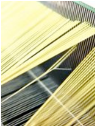
Figuur 20: Verhakingen in het voorvak doorbeschadigde kettingdraden.
