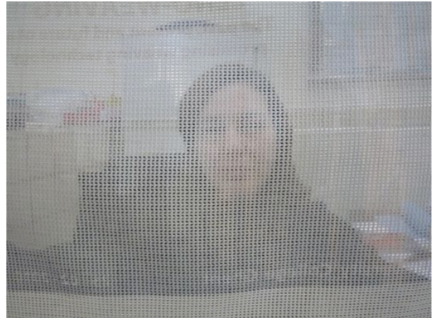
Figuur 7: Eenzijdig bedrukt PVC-gecoat gaasweefsel
