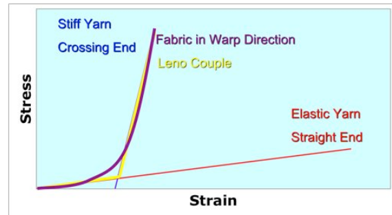
Figuur 10: Afgeronde vorm bij werkelijke rek-trekcurve met knik
