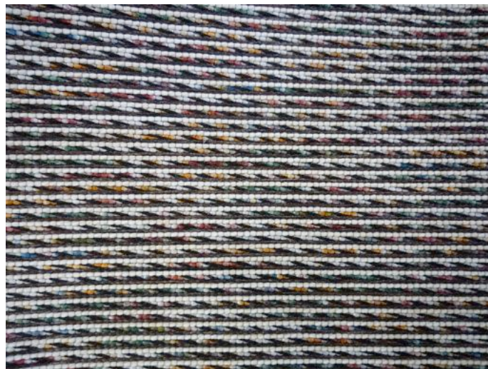
Figuur 17: Leno chenille met zwarte slingerdraad, links = bovenkant, rechts = onderkant
