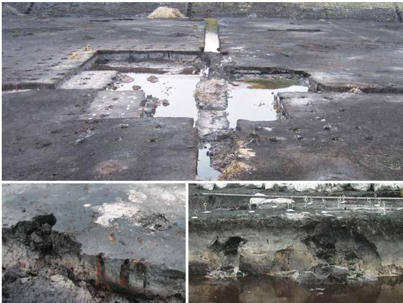
fig. 30 Impressie van de lokalisatie van de megaboringen uit het DAO-1 (opname ROB). De opnames onderaan geven een indruk van de erosie ontstaan ten gevolge van de niet-opgevulde boorgaten in put 85 (links) en put 76 (rechts).
