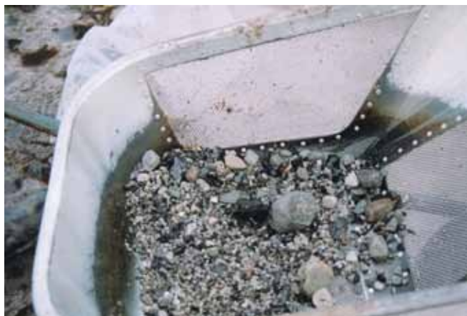
fig. 103 Veldopname van de gezeefde inhoud van een monster uit het keizand met daarin een rijke variatie aan gesteenten.
