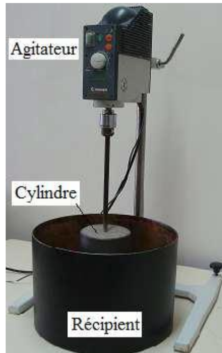
Figure 1-43 Tribomètre développé par NGO (Ngo 2009)
