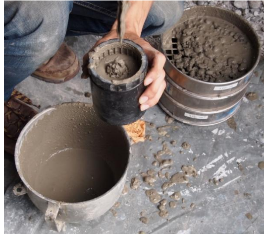
Figure 3-10 Prélèvement du mortier par tamisage
