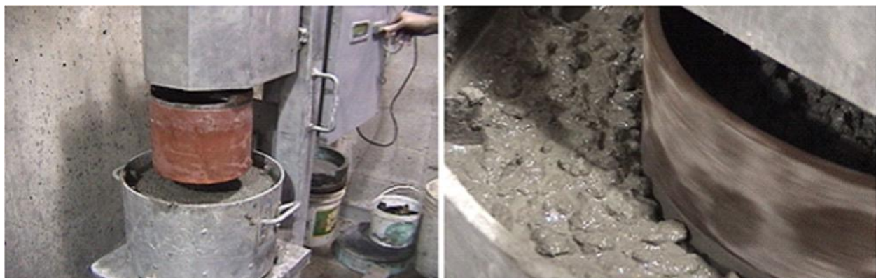
Figure 1-42 Tribomètre développé par Chapdelaine (Chapdelaine 2007)
