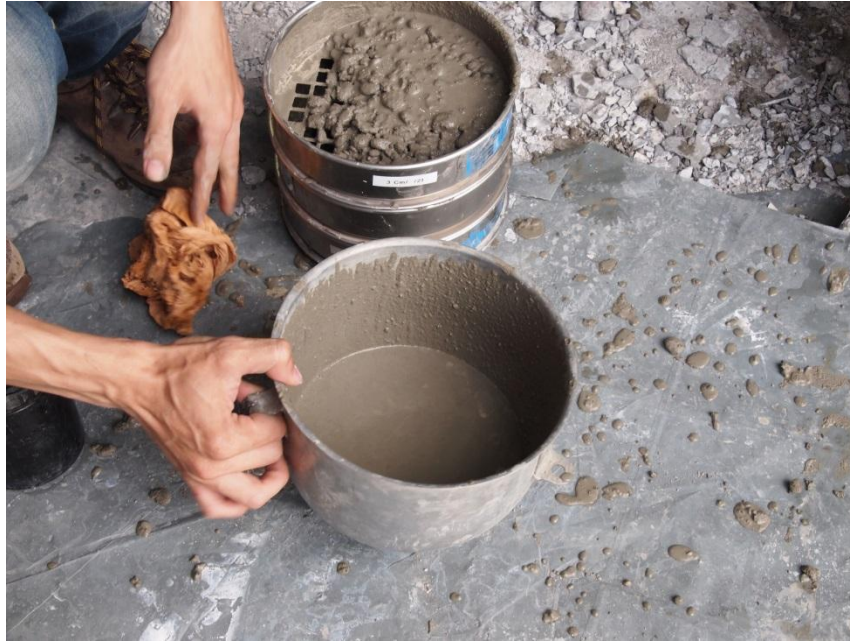
Figure 4-3 Tamiser un des cinq bétons avec le système composé de trois tamis d'ouvertures 10 mm, 8 mm et 4 mm
