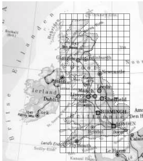
Figuur 2.7: Het berekenen van de fractale dimensie van de kustlijn van Groot-Brittannië; stap 2: bedekking met een fijnmazig rooster.
