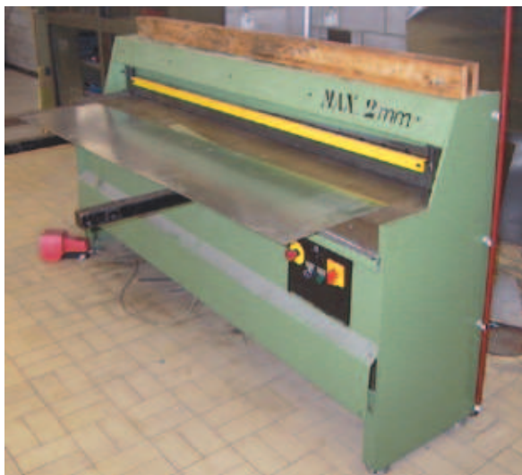
Figuur 3.3: De knipbank waarmee de platen op maat geknipt worden.
