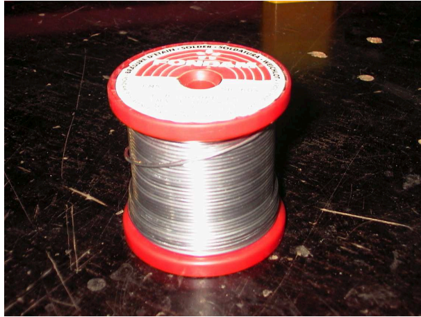
Figuur 3.10: Het toevoegmateriaal bij het gewone soldeerprocédé.
