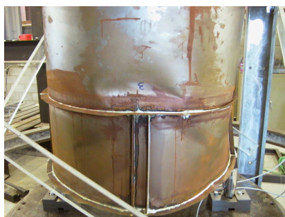
Figuur 4.10: Een detail van de bezweken cilinder bij Proef 5.
