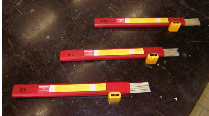
Figuur 3.11: De bagetten van verschillende diameter, gebruikt als toevoegmateriaal bij het solderen met tinzilver.
