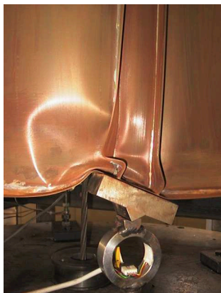
Figuur 4.6: Een detail van de bezweken cilinder bij Proef 3.
