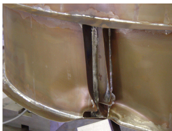
Figuur 4.15: Een detail van de bezweken cilinder bij Proef 7.
