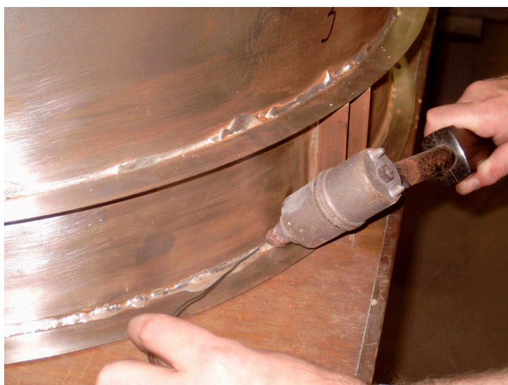
Figuur 3.7: De toegepaste soldeertechniek ter bevestiging van de verstijvers aan de cilinderwand.
