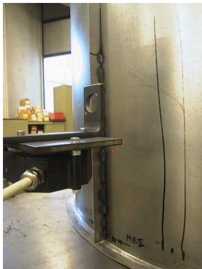
Figuur 3.9: Het opmeten van de imperfecties na het lassen van een verstijver op de cilinderwand.
