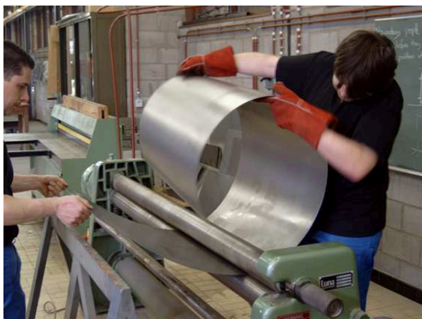
Figuur 3.4: De machine waarmee de platen gerold worden.
