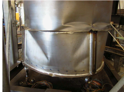
Figuur 4.8: Een detail van de bezweken cilinder bij Proef 4.
