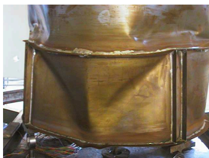
Figuur 4.4: Een detail van de bezweken cilinder bij Proef 2.
