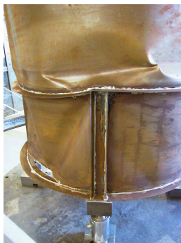
Figuur 4.18: Een detail van de bezweken cilinder bij Proef 8.
