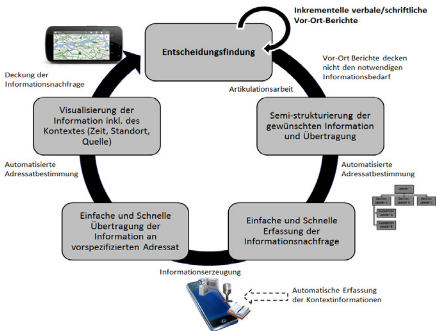
Abbildung 2: Kreislauf semi-strukturierter Informationsanfragen und -berichte
