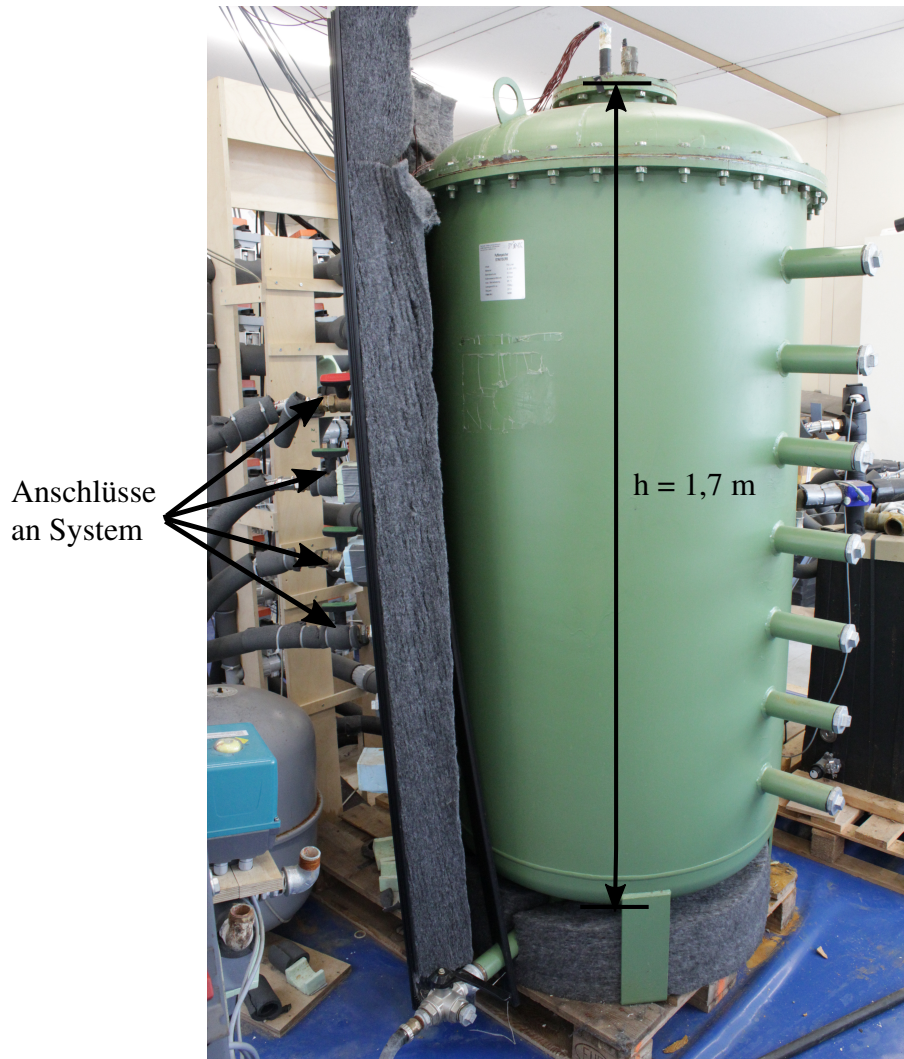
Abbildung B.2.: Blick auf den verwendeten Pufferspeicher.
