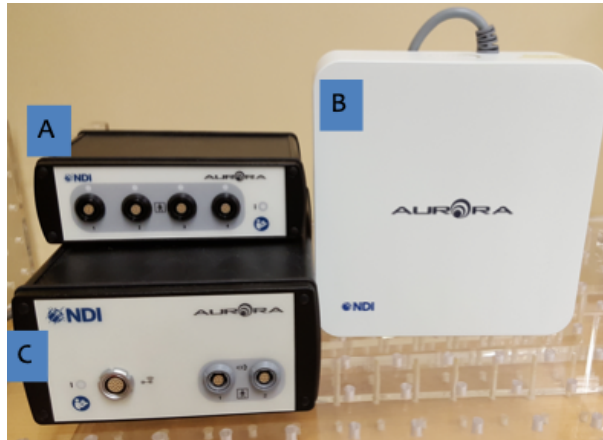
FIGURE 1.7 – Système de suivi électromagnétique Aurora. A) Interface des capteurs B) Générateur de champ C) Boîte de contrôle
