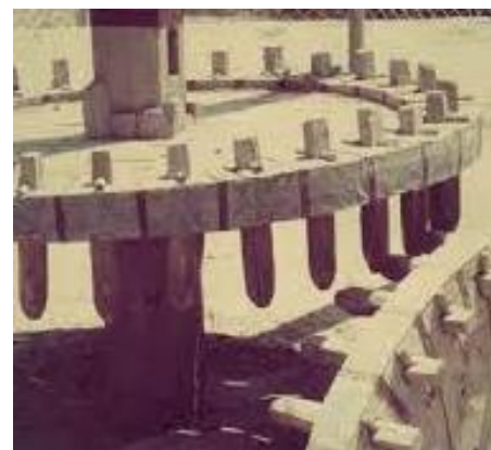
Fig. 20 Engrenagens primitivas (China no Séc. III a.C.)
