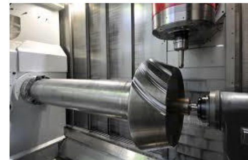
Fig. 8 Processos de fabrico de rodas dentadas metálicas: fundição e maquinagem
