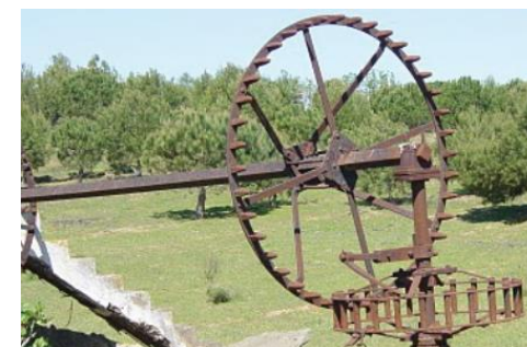
Fig. 21 Engrenagem de uma nora
