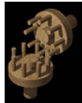
Fig. 20 Engrenagens primitivas (China no Séc. III a.C.)
