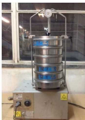
Figura 39 – Peneiração mecânica dos agregados resultantes do processo de determinação da percentagem de ligante por ignição
