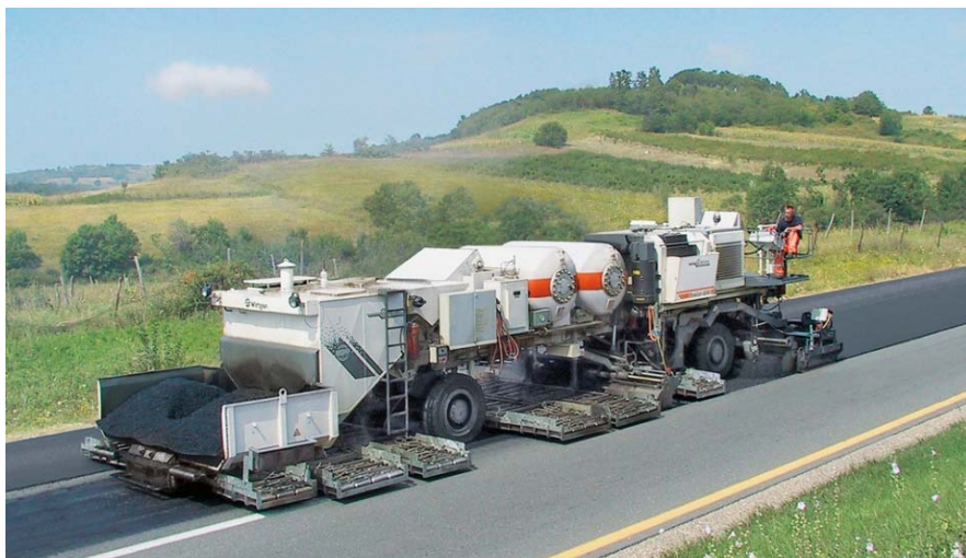
Figura 2 – Central móvel para reciclagem de pavimentos flexíveis a quente in situ (Wirtgen, 2016b)
