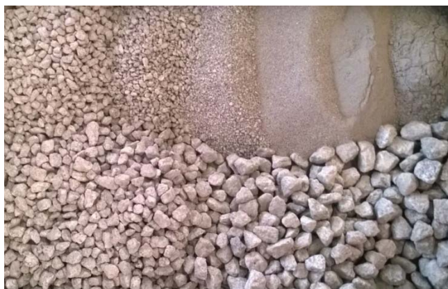
Figura 55 – Agregados resultantes da separação do material incinerado para determinação da percentagem de ligante da mistura aplicada no trecho correspondente à superfície C
