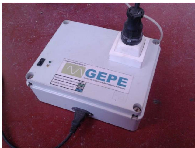
Figura 28 – Multímetro utilizado para medição do consumo de energia
