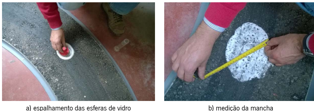
Figura 41 – Realização do ensaio da mancha de areia num dos trechos em estudo
