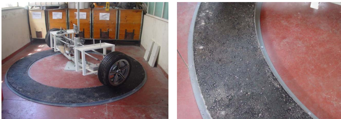
Figura 46 – Trecho construído com mistura AC 14 surf (superfície A)
