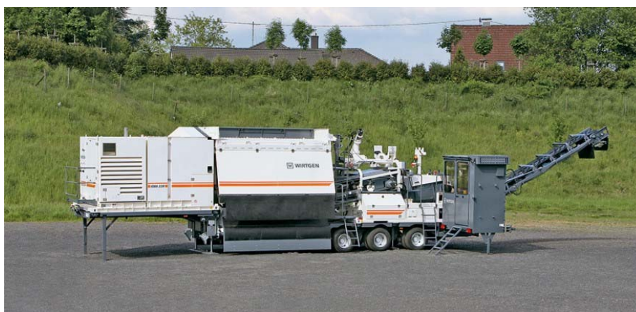
Figura 3 – Central móvel para a produção de misturas recicladas a frio (Wirtgen, 2016a)
