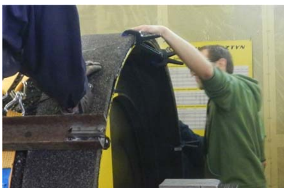
c) Colocação das réplicas das superfícies utilizadas no tambor da TUG (Sandberg et al. , 2013)
