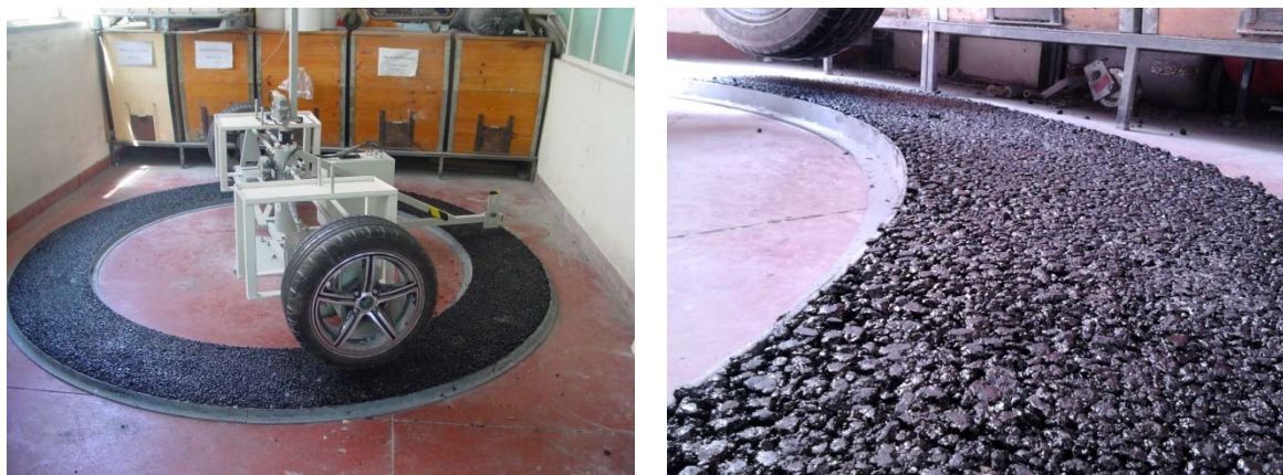
Figura 54 – Trecho construído com mistura PA 12,5 (superfície C)
