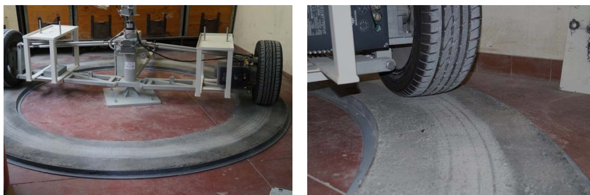
Figura 50 – Trecho resultante da sobreposição à superfície anterior (AC 14 surf) de slurry seal (superfície B)
