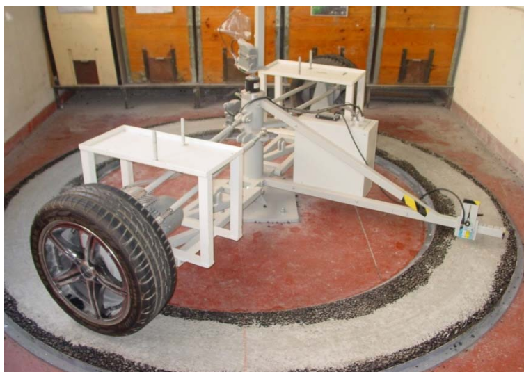
Figura 42 – Laser utilizado para medição e registo do perfil das superfícies do pavimento em estudo
