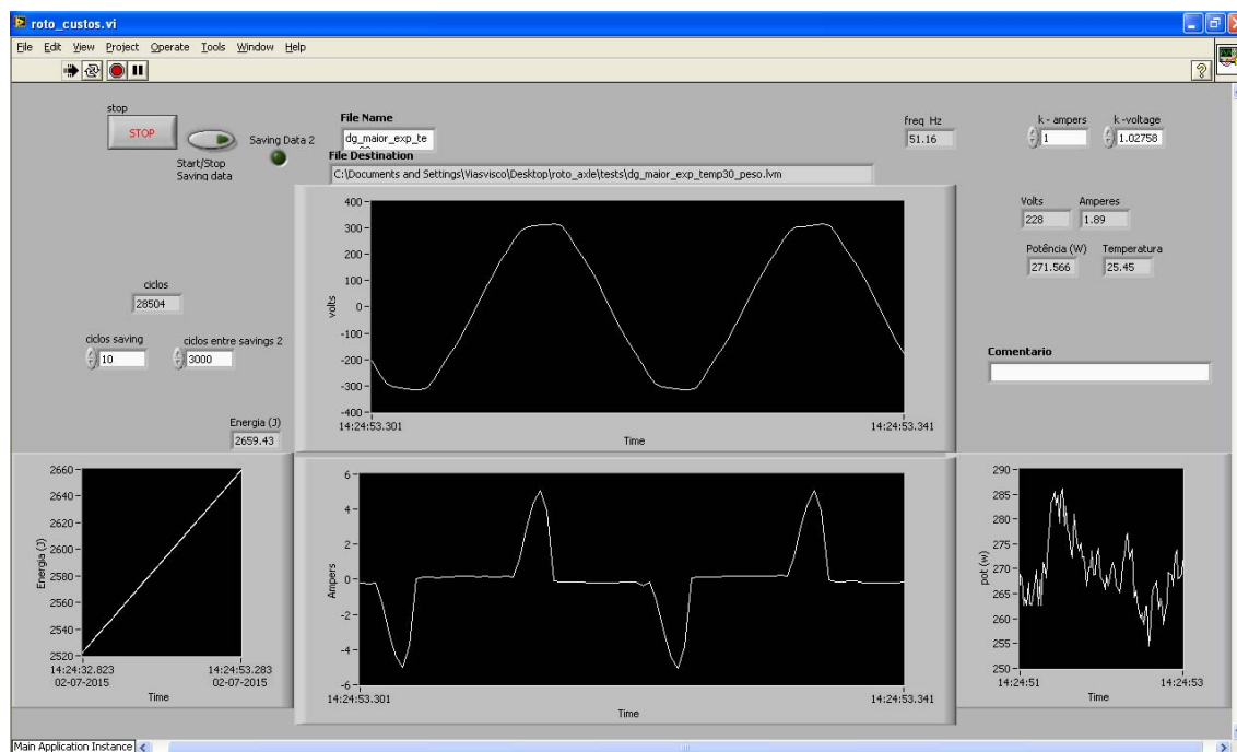
Figura 30 – Painel frontal da aplicação desenvolvida para monitorização do consumo de energia
