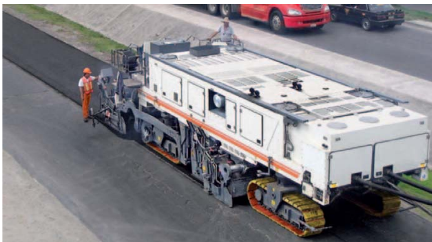
Figura 4 – Equipamento utilizado para reciclagem a frio in situ com ligantes betuminosos (Wirtgen, 2012)
