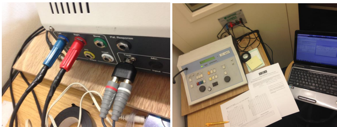
Figura 2 – (a) e (b) Ligações entre o computador, o audiómetro e a cabine audiométrica
