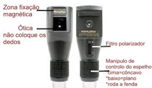
Figura 6: Componentes principais de um retinoscópio.
