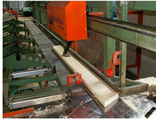
Figura 18 - Corte de peças de madeira em máquina CNC ( http://frame-house.eu )
