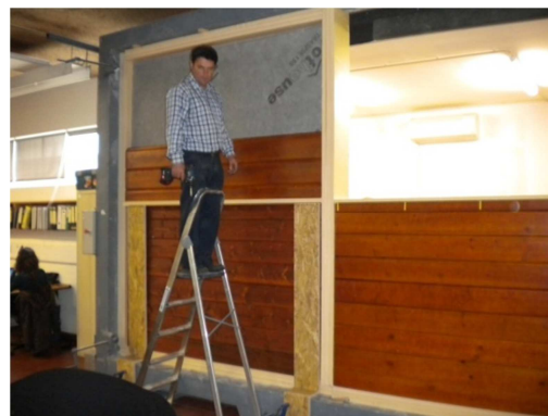
Figura AI- 8 - Montagem do provete 2, solução construtiva tronco maciço de 7cm de espessura.
