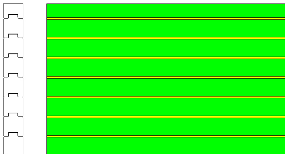
Figura 55 - Representação das áreas consideradas no cálculo da média ponderada para o provete 1
