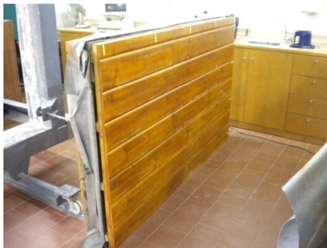
Figura AI- 5 - Provete 4, solução construtiva Clóvis antes da sua colocação no pórtico de ensaio.
