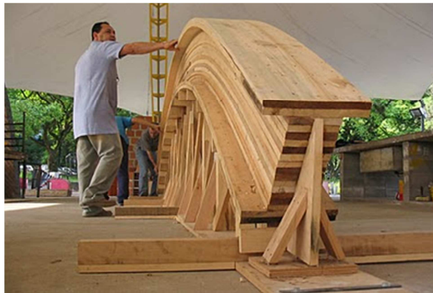
Figura 28 - Madeira lamelada ( http://portaldamadeira.blogspot.pt )
