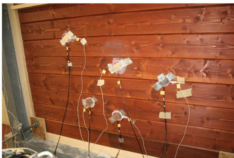
Figura 53 - Posição dos fluxímetros e termopares para a 1ª análise.
