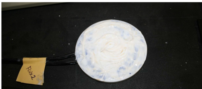
Figura 51 - Superfície de contacto do fluxímetro envolta em pasta de dentes
