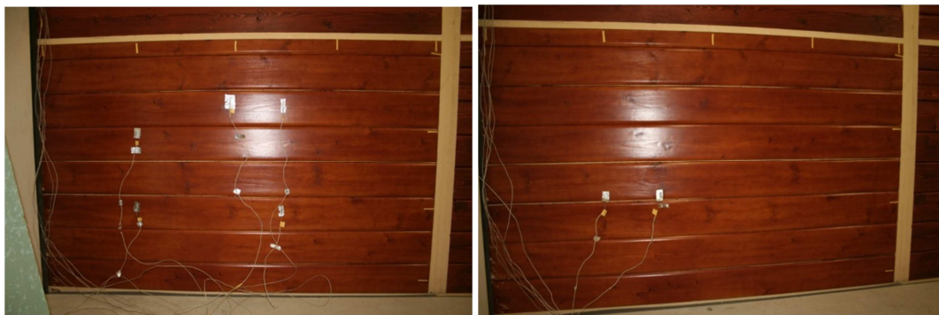
Figura 74 - Retração do revestimento interior do provete 4.
