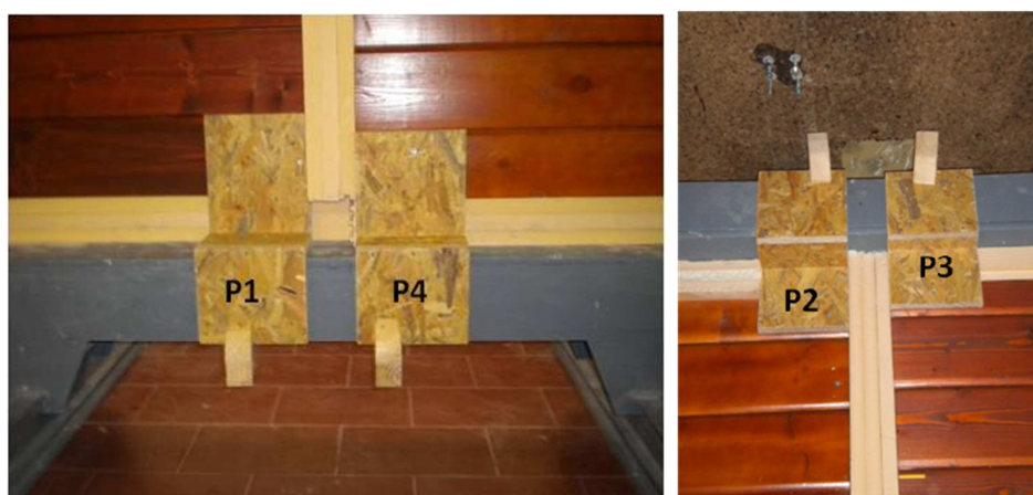
Figura AI- 13 - Sistema de fixação da zona central suportando o provete 1 e provete 4. Sistema de fixação da zona central suportando o provete 2 e provete 3.
