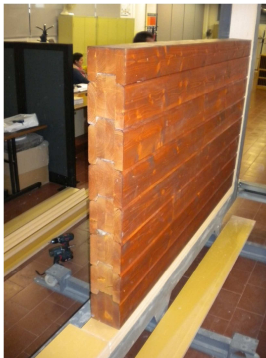
Figura 38 - Provete 1 solução construtiva em tronco maciço de 16cm finalizado
