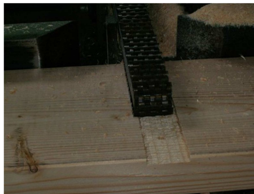
Figura 19 - Realização de entalhes ( http://frame-house.eu )
