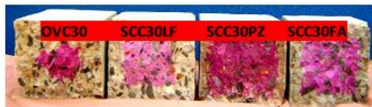
Figura 4.14: Frente de carbonatação acelerada (Siad et al., 2013).
