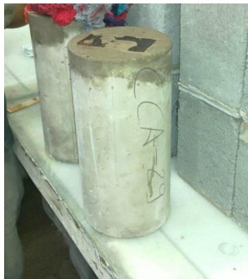
Figura 7.5: CPs cilíndricos de 150 x 300 mm para o ensaio de absorção de água por capilaridade.
