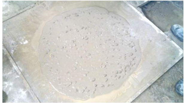
Figura 6.58: CAA após realização do ensaio
