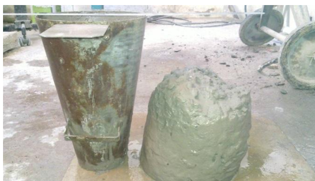
Figura 6.69: Realização do ensaio de abatimento
