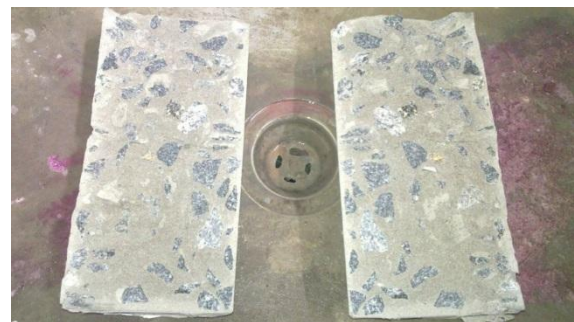
Figura 7.25: CP após rompimento
