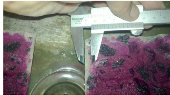
Figura 7.27: Medição da frente de carbonatação
