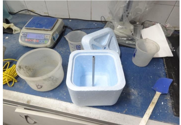
Figura 6.38: Detalhe da caixa térmica
