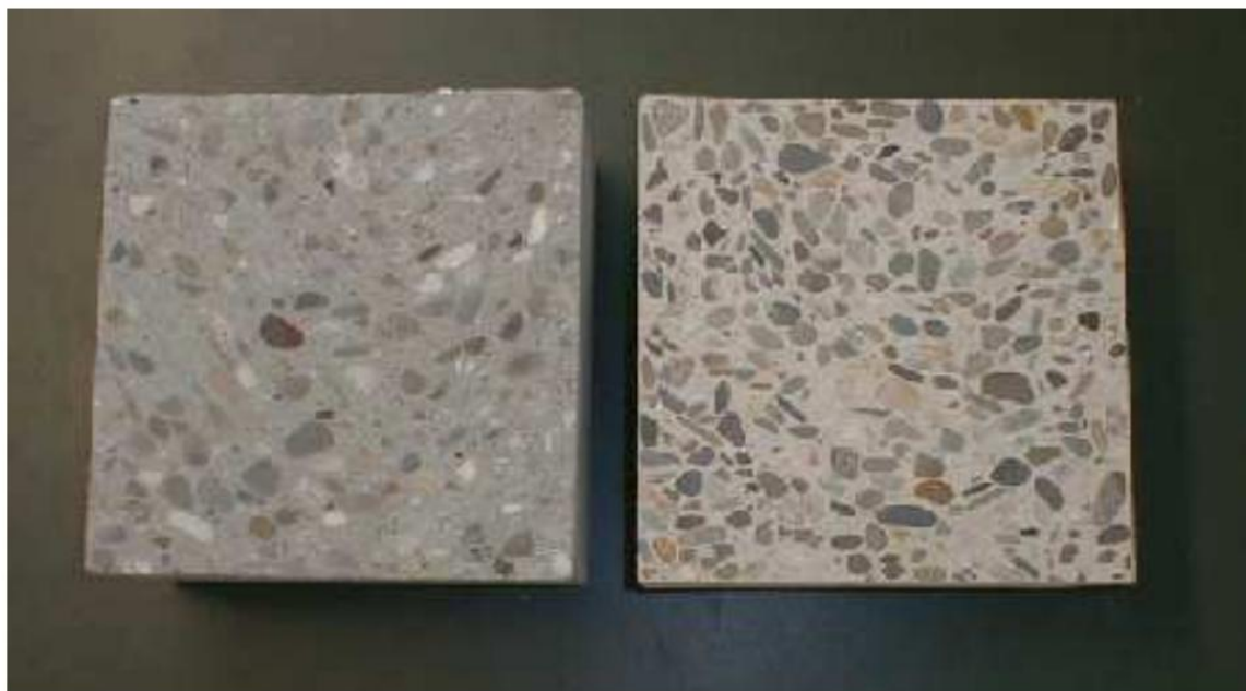
Figura 2.1: Fotos do CAA (esquerda) e CC (direita) (De Schutter, 2012).
