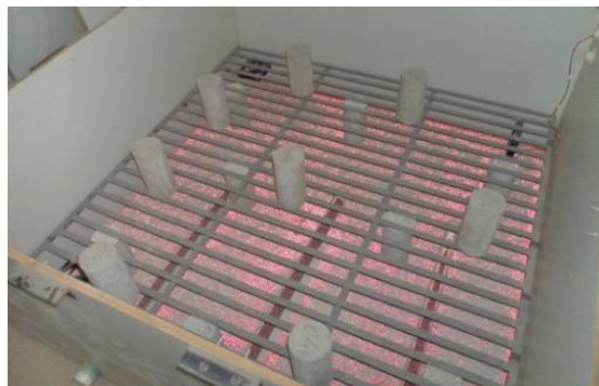
Figura 7.23: CPs na câmara de carbonatação.
