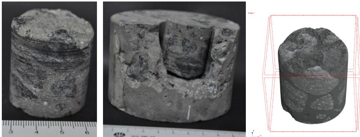
Figura 7.54: Imagens da amostra de CC retirada para aplicação no ensaio de micro tomografia.
