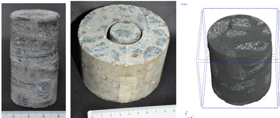
Figura 7.49: Imagens da amostra de CAA retirada para aplicação no ensaio de micro tomografia.
