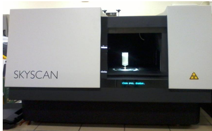
Figura 7.48: Foto do micro tomógrafo SKYSCAN 1173.
