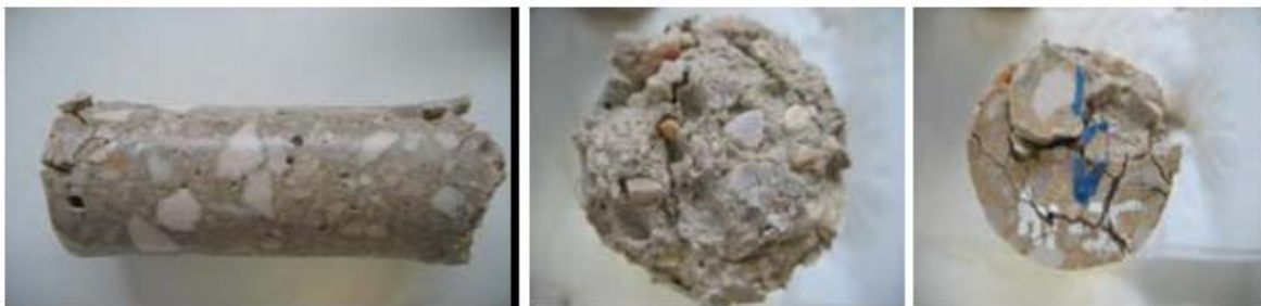
Figura 4.8: Fotos das amostras CEM II/49 em completa imersão (Kelifa et al. , 2010).
