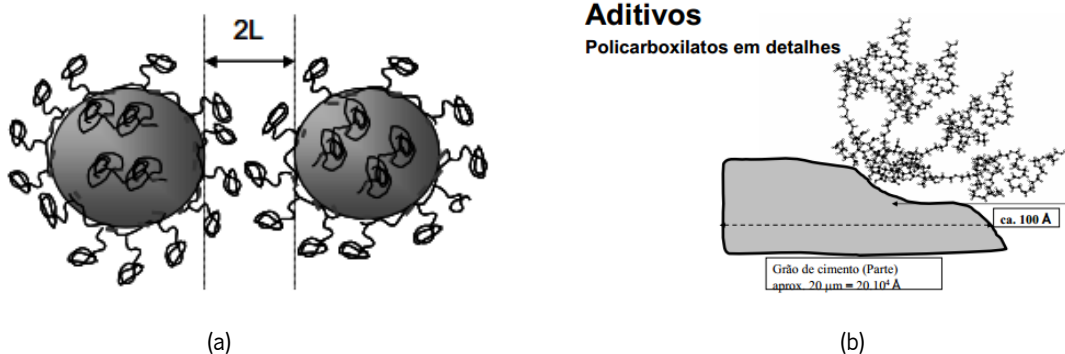
Figuras 2.5 (a) e (b): Esquema indicativo da repulsão eletrostática (Belohuby, 2009).
