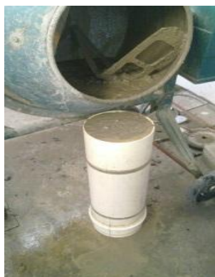
Figura 6.66: Preenchimento coluna de segregação
