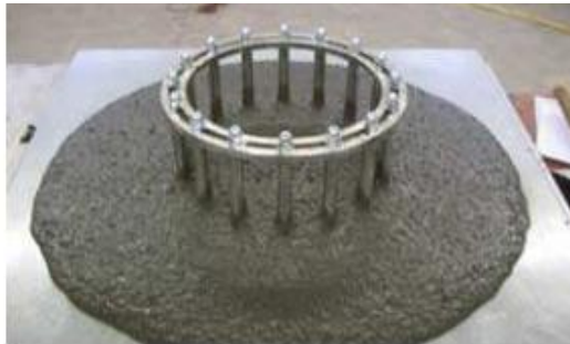
Figura 3.63: Foto de ensaio com anel J (Desnerck, 2010).
