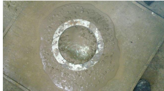
Figura 6.62: CAA após realização do ensaio
