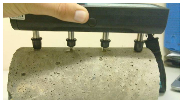
Figura 7.18: Medição da resistividade elétrica
