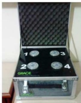
Figura 3.43: Calorímetro semi-adiabático AdiaCal (Masuero et al. , 2012).
