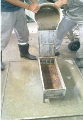
Figura 6.63: Colocação do CAA
