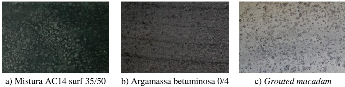
Figura 2 Aspeto superficial das misturas ensaiadas com o protótipo
