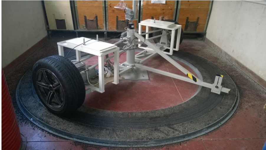
Figura 1 Protótipo desenvolvido para avaliação da resistência ao rolamento
