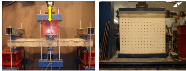
Figura 9: Provetes de alvenaria reforçados com reboco armado: (a) configuração do ensaio de flexão; (b) configuração de ensaios cíclicos no plano [26]
