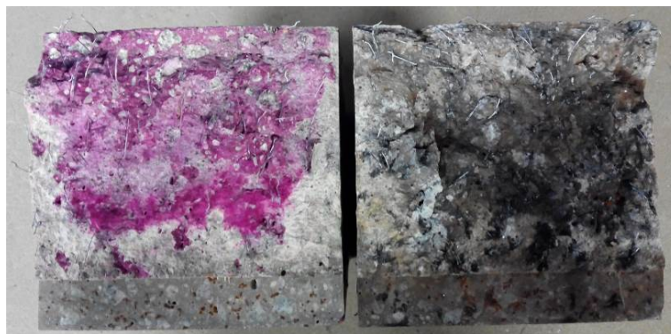
Figura 8 – Perfil da penetração de cloretos (face esquerda) e da carbonatação (face direita).
