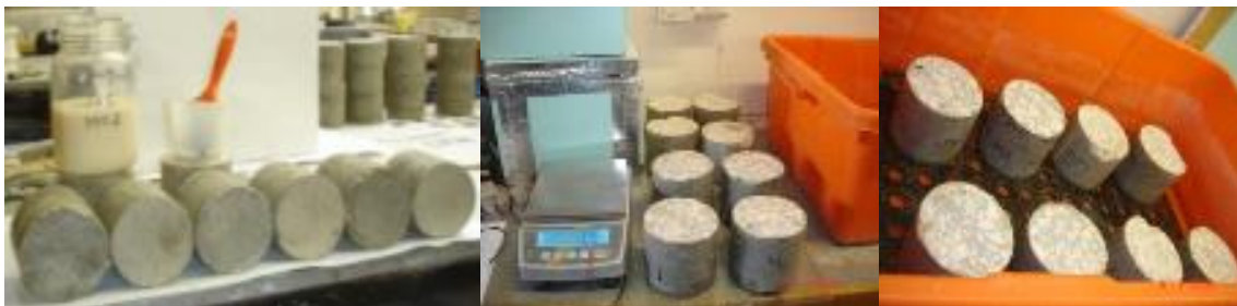
Figura 3. Ensaio de absorção de água por capilaridade à pressão atmosférica.
