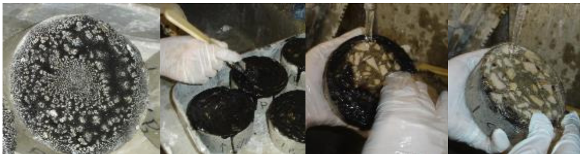
Figura 1. Processo de remoção da tinta em spray da superfície do betão com proteção.
