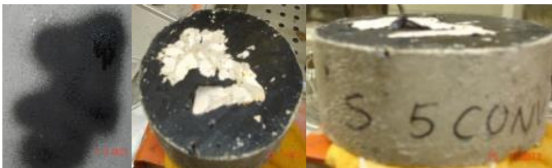
Figura 2. Processo de remoção da tinta da superfície do betão com proteção sacrificial AGS 2 .
