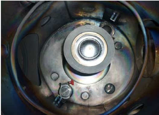
Figura 3 Reator de deposição de nanopartículas de \text{TiO}_2
