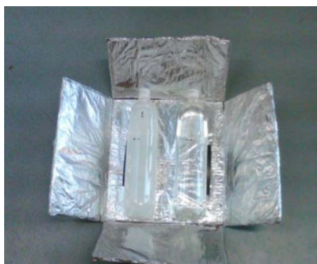
Figura 1 Reator fotocatalítico heterogêneo com \text{TiO}_2 suspenso
