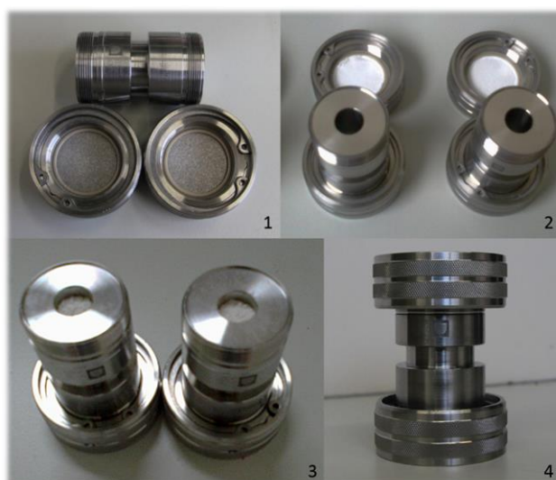
Figura 34. Células de extração (5 mL) do ASE. 1- Célula desmontada nas suas 3 principais peças, duas “tampas” e o “corpo” da célula; 2- Células prontas para receber a amostra com os filtros nas “tampas”; 3- Células com a amostra; 4- Célula fechada pronta para a extração.
