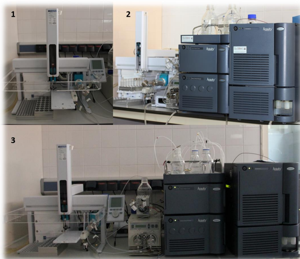
Figura 39. Equipamento utilizado na separação e deteção dos compostos – UPLC-MS/MS. 1- amostrador automático e injetor; 2- em primeiro plano o sistema de separação e deteção dos compostos; 3- visão geral do UPLC com, da esquerda para a direita: amostrador, bomba e SPE “online”, solventes e coluna, detetor.
