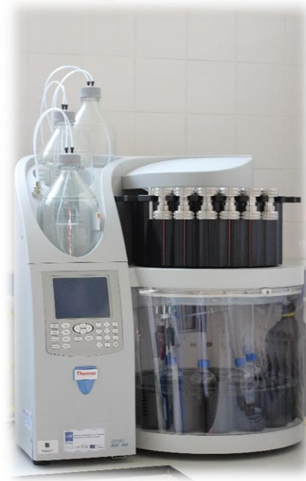
Figura 35. Equipamento utilizado na extração das amostras – ASE350.
