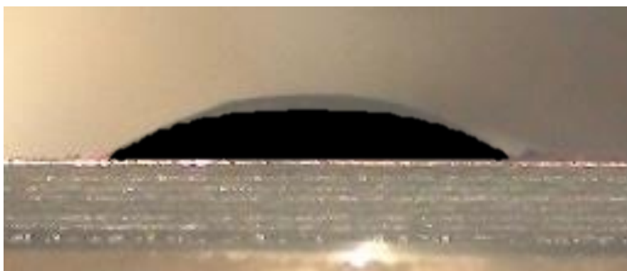
Figura 5.26 – Sobreposição da imagem fotográfica do teste prático com o resultado simulado com um ângulo de contacto de 37^\circ e tensão superficial de 0.5 N/m
