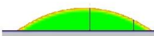
Figura 5.17 - Geometria obtida para uma tensão superficial de 0.75 N/m.
