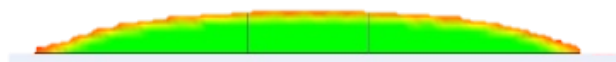
Figura 5.24 – Resultado obtido da simulação da fusão da liga SAC 305 em substrato de NiAu com 0.75 N/m de tensão superficial.
