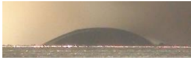
Figura 5.22 – Geometria obtida em laboratório para a solda SAC 305 em substrato de NiAu aos 508.15K.
