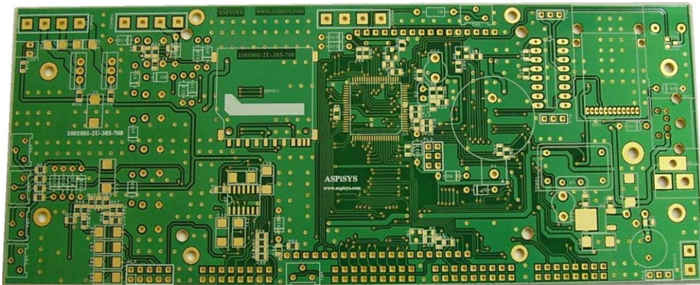
Figura 2.1- Exemplo de uma placa de circuito integrado sem componentes soldados.
