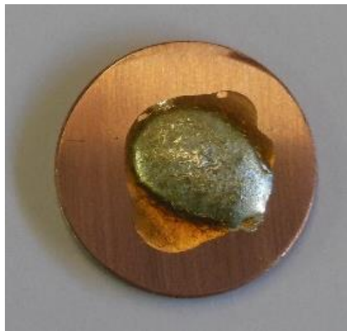
Figura 5.19 – Amostra da solda SAC 405 em substrato de cobre onde é visível a acumulação do fluxo.
