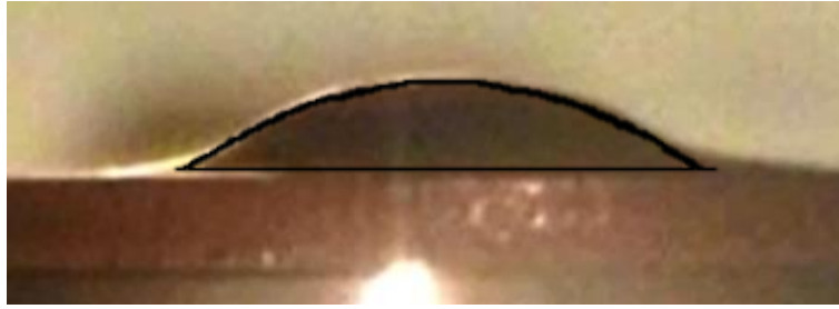
Figura 5.18 – Sobreposição do perfil do menisco obtido em simulação com a imagem retirada do teste em laboratório.
