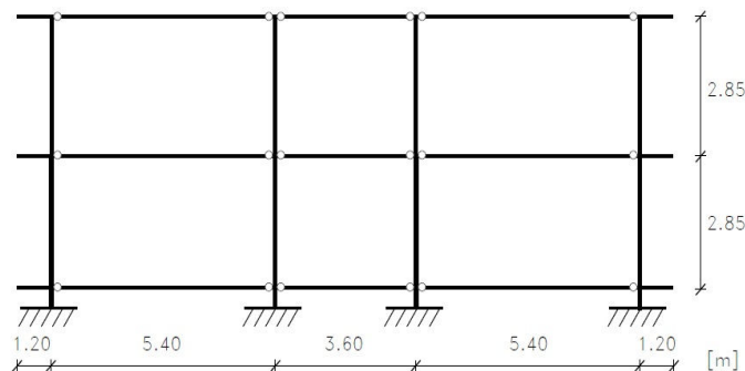
Figura 6. Pórtico transversal - Modelo 1
