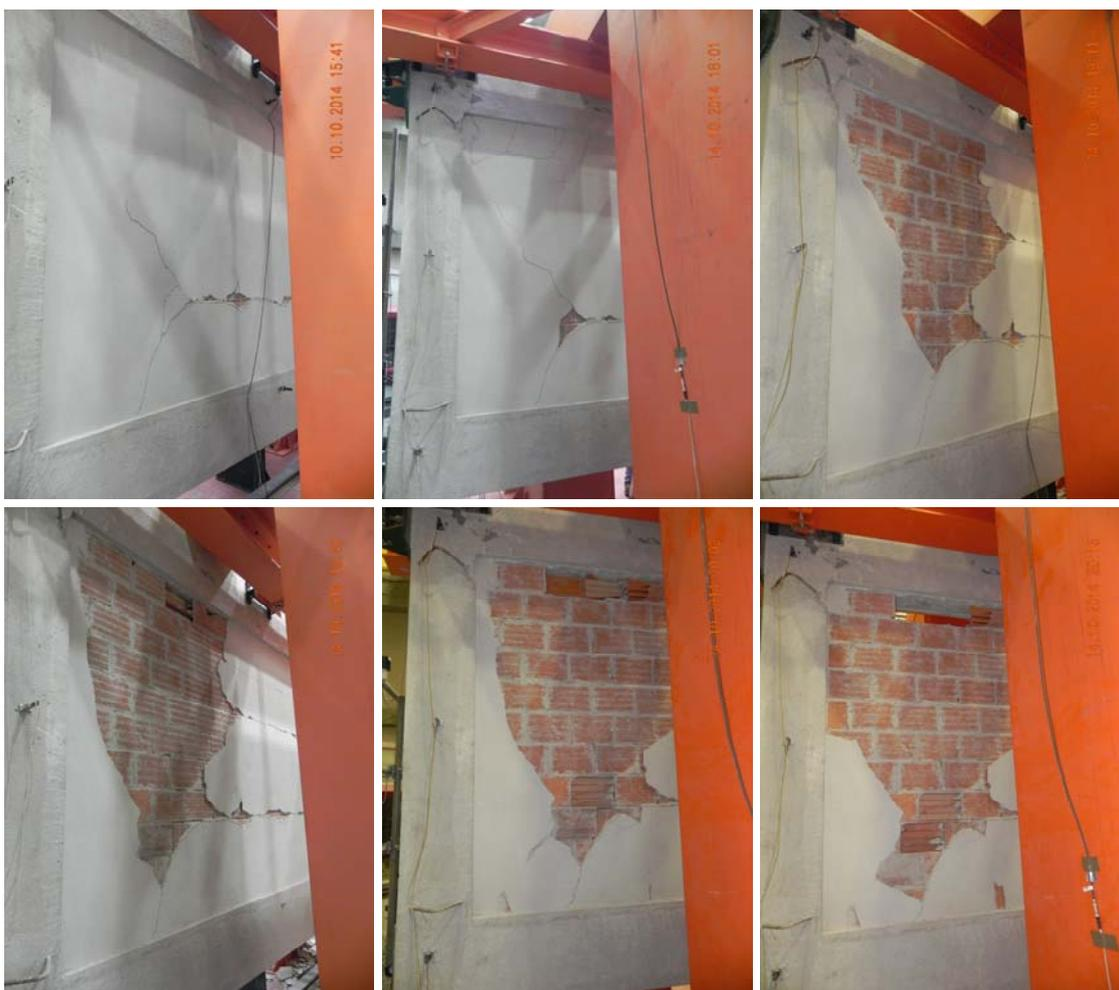
Figura 20. Evolução do dano observado no segundo modelo, desde o final do nível 2 da acção sísmica (63% do nível de ref.) até ao final do nível 6 (292% do nível de ref.).
