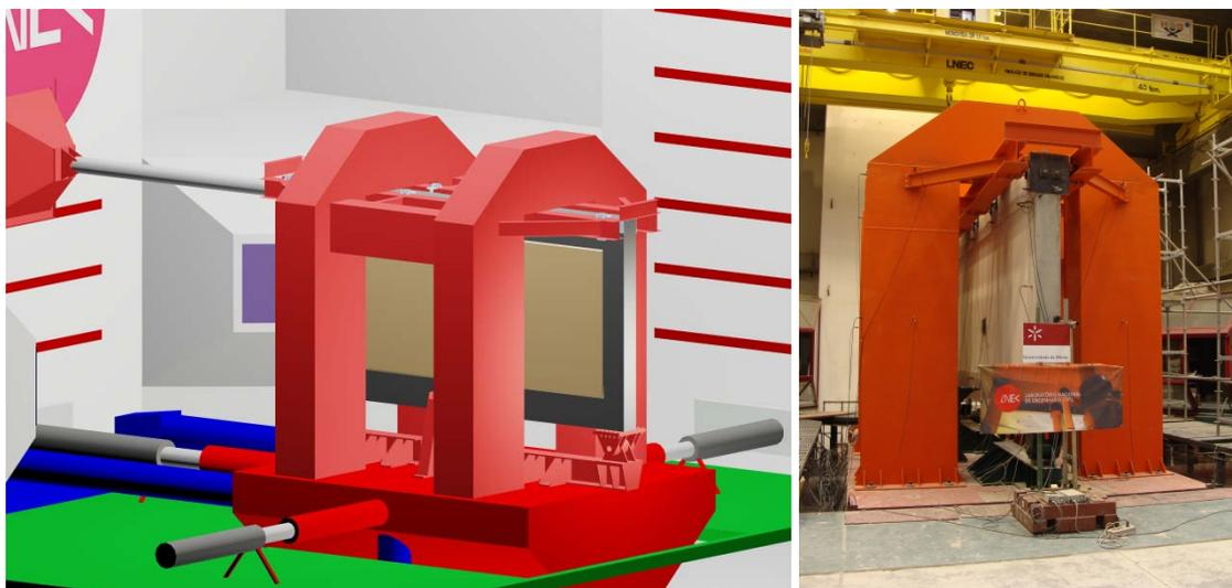
Figura 2. Representação global do dispositivo de ensaio.
