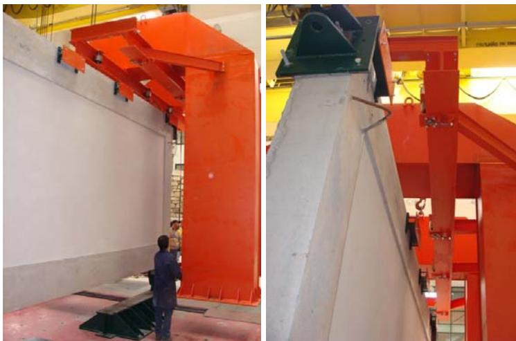
Figura 17. Posicionamento da TIM em redor do modelo a ensaiar.
