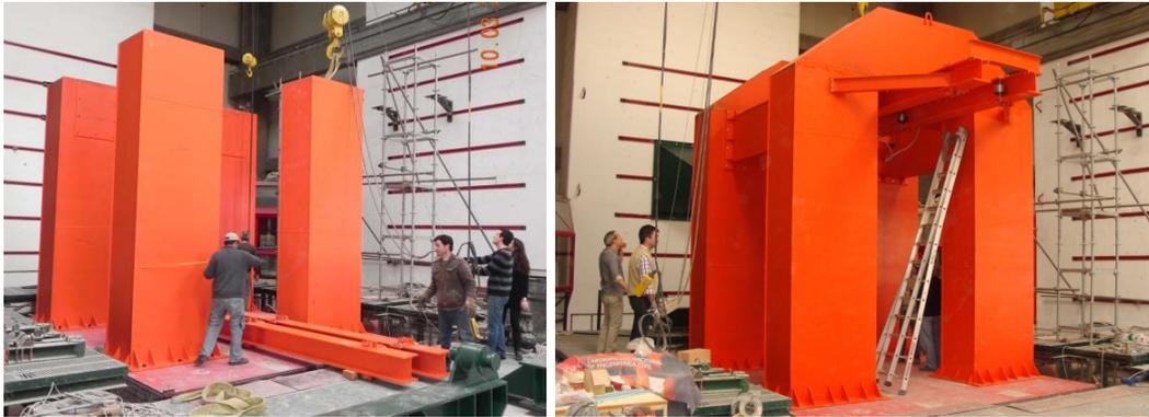
Figura 15. Montagem final dos componentes da TIM sobre a plataforma sísmica.
