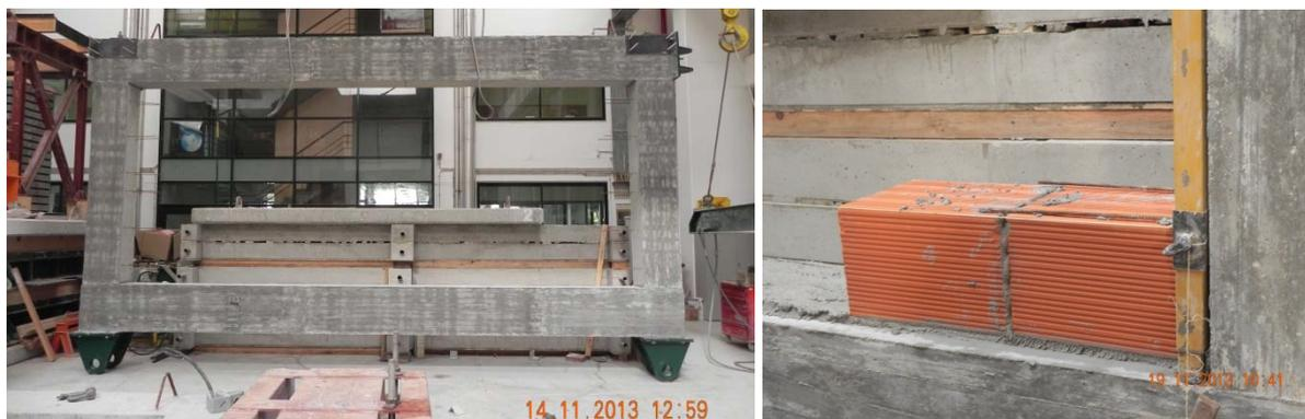
Figura 11. Pórtico preparado para a construção da parede de enchimento.
