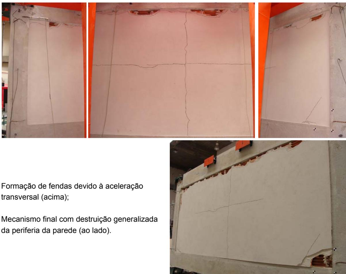
Formação de fendas devido à aceleração transversal (acima);
