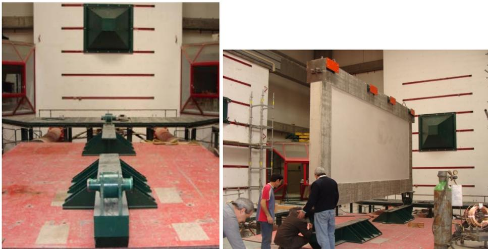
Figura 16. Suportes rotulados na base e pirâmide de ligação à parede de reacção.
