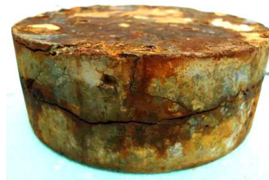
Figura 14. Corrosão superficial e macro-fendilhação observada nos provetes ensaiados (face superior exposta à solução anódica)
