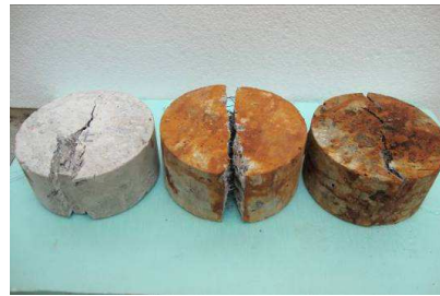
Figura 13. Provetes de BACRFA com e sem exposição à migração de cloretos
