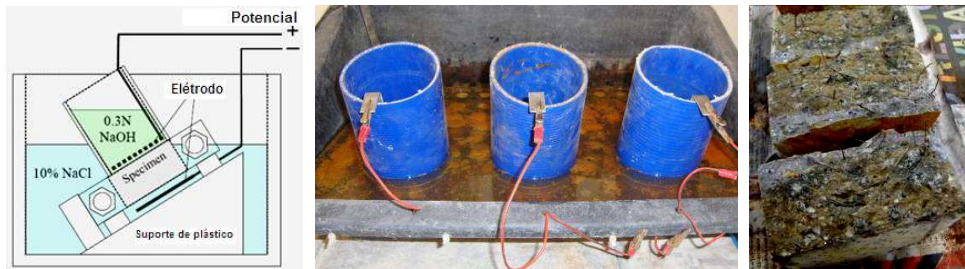
Figura 10. Ensaio acelerado de migração de cloretos
