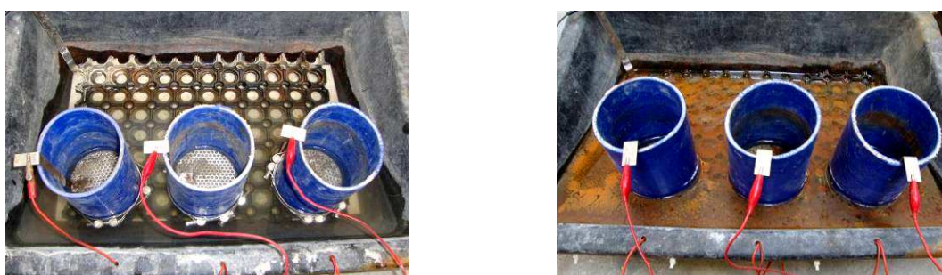
Figura 12. Observação da formação de resíduos provenientes da corrosão das fibras de aço antes (esquerda) e depois (direita) do ensaio
