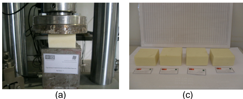
Figura 8. Amostras de PU ensaiadas: (a) durante o ensaio; (b) após ensaio.
