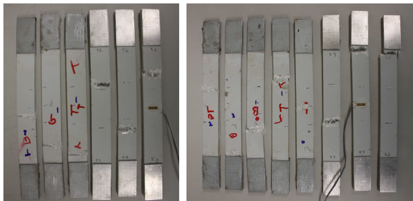
Figura 7. Amostras de GFRP ensaiadas: modos de rotura.
