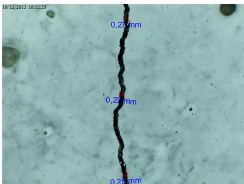
Figura 5. Medição da largura de fendas
