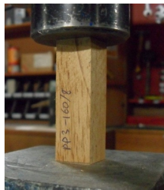
Fig. 5 – Ensaio de compressão uniaxial.
