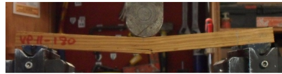
Fig. 3 – Ensaio de flexão estática sob 3 pontos de carga
