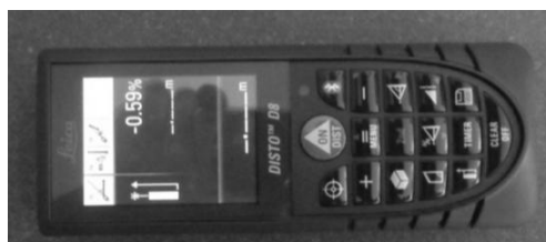
Fig. 3 Aferição com o DISTO D8 diretamente sobre o terreno
