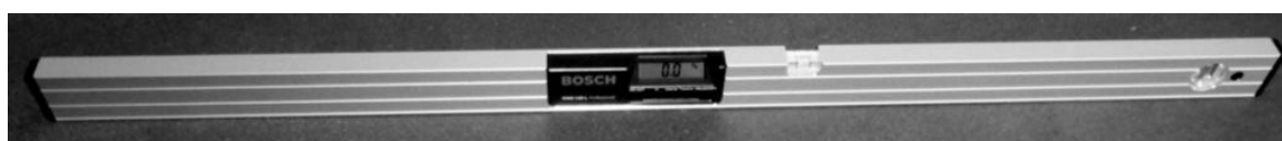
Fig. 2 Aferição da inclinação com o medidor DMN 120L
