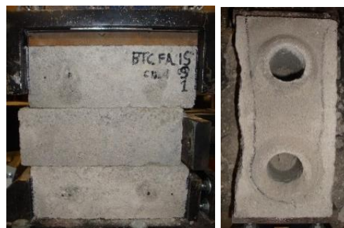
Fig. 12 – Modo de rotura típico dos prismas ensaiados ao corte.
