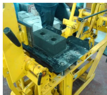
Fig. 3 – Fabrico de um BTC na prensa Terstaram.
