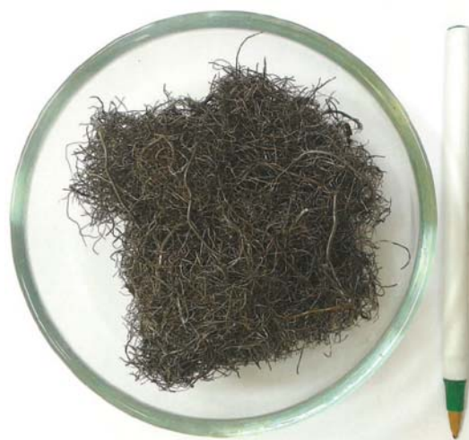
Figura 5: fibre di acciaio riciclate da pneumatici
