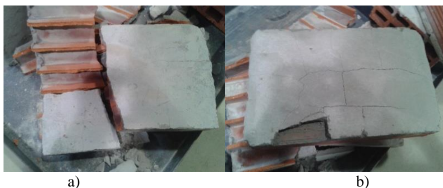
Figure 7 – Argamassas à base cimento submetidas a 600°C: a) 0% de PCM; b) 40% de PCM e 1% de fibras.
