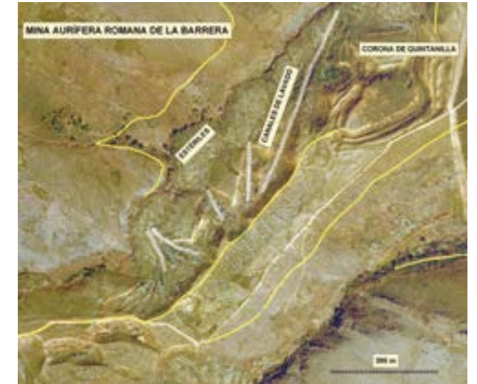
Figura 8 "Corona de Quintanilla": esquema del abastecimiento hidráulico de la mina conocida como "La Barrera" (4,5 km de extensión) y zonas de lavado (Luyego-León).
