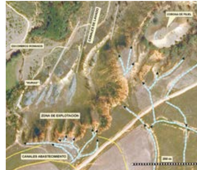
Figura 7 Ortoimagen interpretada del esquema de explotación de la "Corona de Filiel" en donde se aprecian con claridad los canales de lavado que se sitúan a continuación de las zonas de arranque (Filiel-León).
