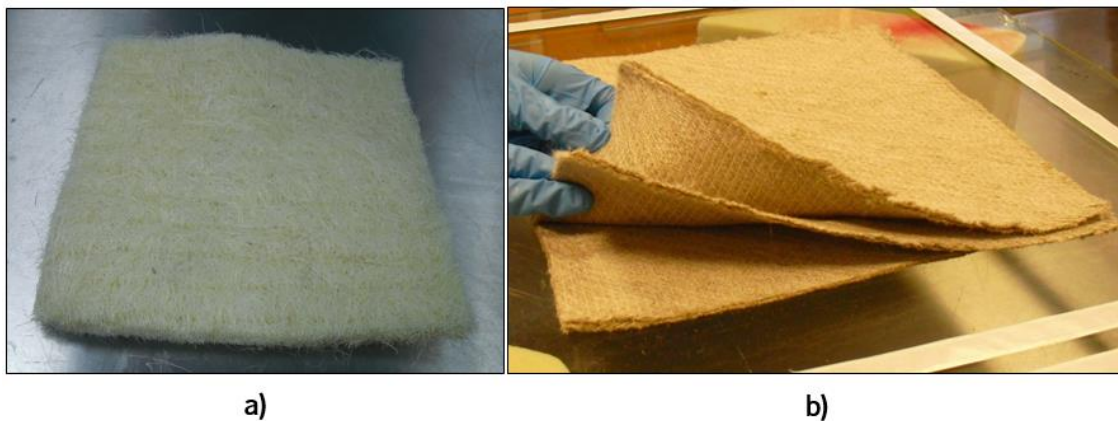
Figura 45 - Fibras de reforço com dimensões (300 x 300 mm) para 1 laminado de fibras de sisal (a) e para 3 laminados de fibra de linho (b)
