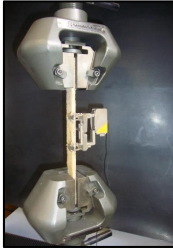
Figura 38 - Extensómetro utilizado durante o ensaio de tração, para a medição de deslocamento até 0,3mm
