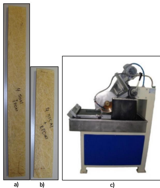
Figura 36 - Provette de tração de (250 x 25 mm) (a), provete de flexão de (100 x 25 mm) (b), serra de disco adiantado para maquinação de provetes (c)
