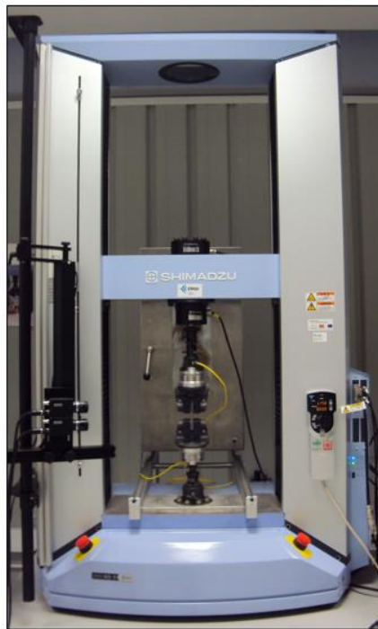
Figura 25 - Equipamento de ensaios de tração universal Shimadzu
