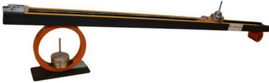
Figura 30 - Equipamento Malhímetro ( Maillemètre ) para determinação da massa linear dos fios de tecido de linho
