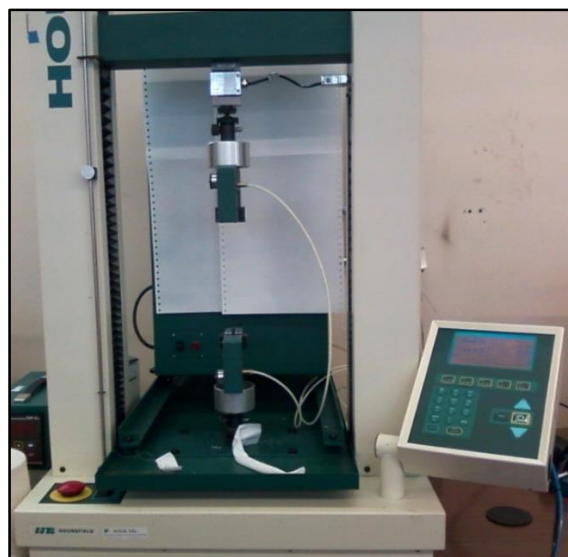
Figura 32 - Equipamento de ensaio de tração universal Hounsfield
