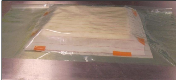
Figura 50 - Laminado de fibras de sisal envolvidas por “peel ply”, seguido de saco de vácuo
