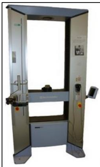
Figura 37 - Equipamento de ensaio de tração universal Shimadzu Autograph AG - X Series
