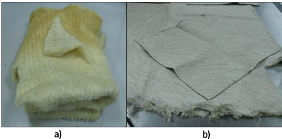
Figura 16 - Fibras de sisal na forma de manta (a) e fibras de linho na forma de tecido (b)
