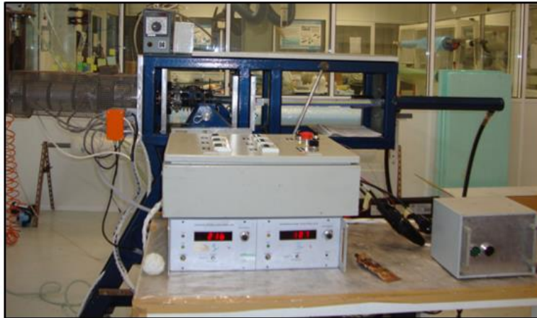
Figura 55 - Misturadora utilizada para a mistura do polímero de PLA e da fibra de reforço
