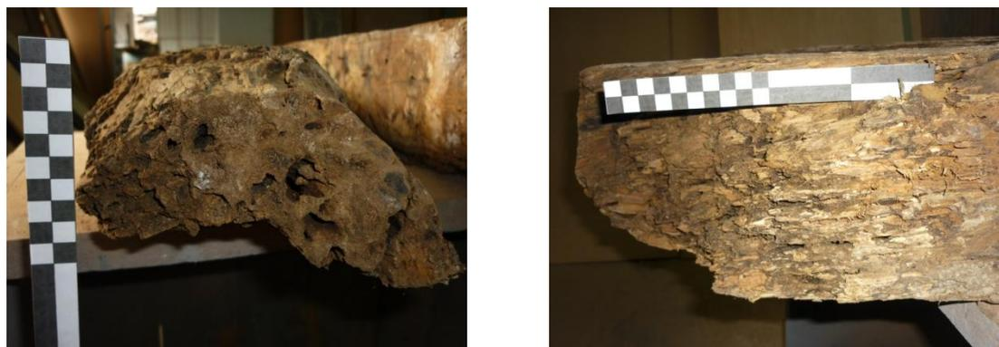
Figura 8 – Exemplos de degradação biológica de vigas de madeira.
