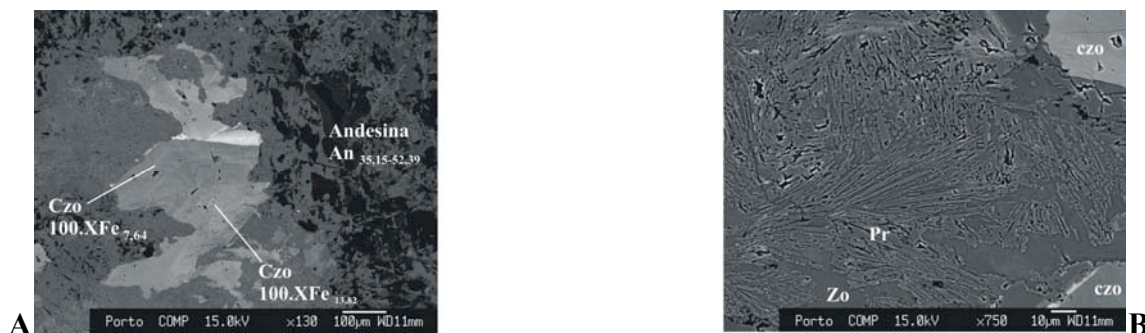
Fig. 2 – Discriminação dos intercrescimentos observados entre os minerais dos veios terminais ( \pi_3 ). A - cristal grosseiro subédrico de clinozoisite (Czo) com aspectos de corrosão. B – intercrescimento simplitítico entre zoizite (Zo) e agregados de prenite (Pr) prismática. XFe = Fe^{3+}/(Fe^{3+}+Al) (Deer et al., 1986).
