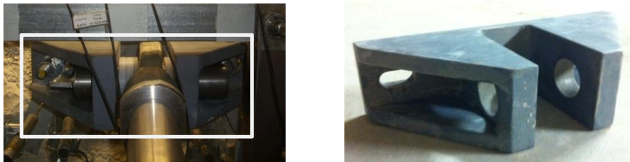
Figura 5.5 - . Detalhe da ligação entre o atuador e as ancoragens para aplicação da força.
