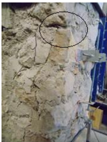
Figura 4.12 – Zona com fenómeno de embrincamento em MP6.
