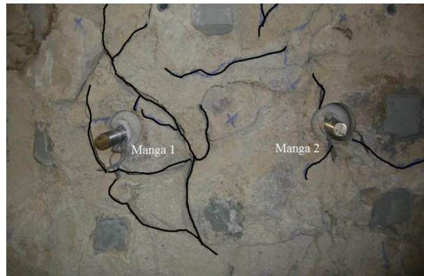
Figura 5.11 – Formação do cone de corte na proximidade da manga 1 em WT.40.I.1A.
