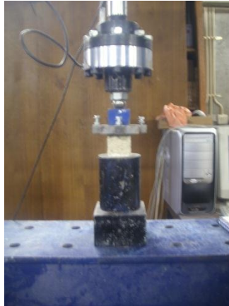
Figura 4.2 – Setup para ensaios de compressão nos provetes de argamassa.
