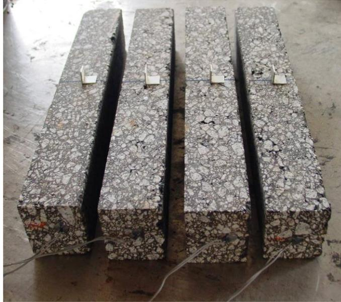
Figura 4.9 – Provetes prismáticos (vigas) com materiais piezoelétricos incorporados
