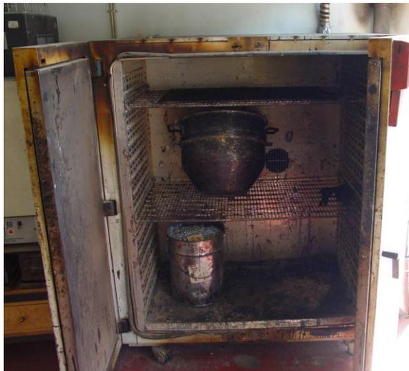
Figura 4.1 – Aquecimento em estufa dos agregados para a mistura
