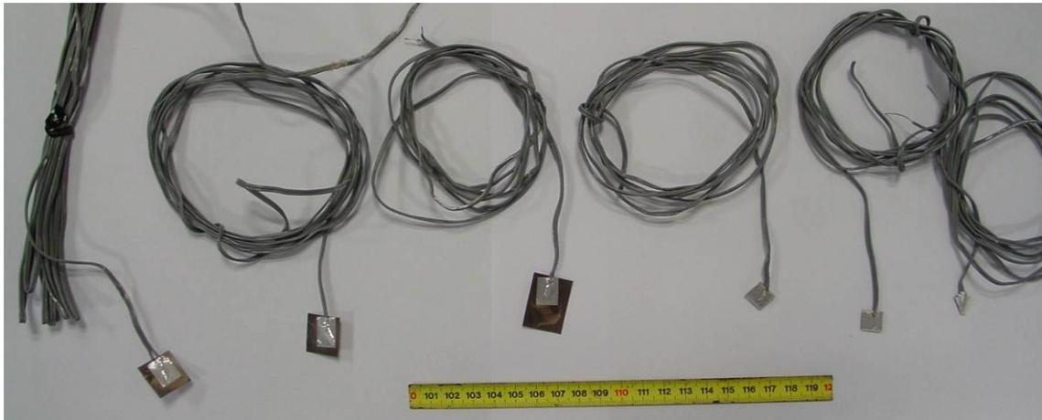
Figura 5.2 – Materiais piezoelétricos instalados no pavimento da estrada às várias profundidades
