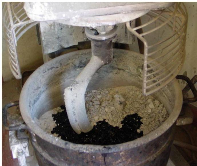
Figura 4.3 – Adição do betume aos agregados na misturadora
