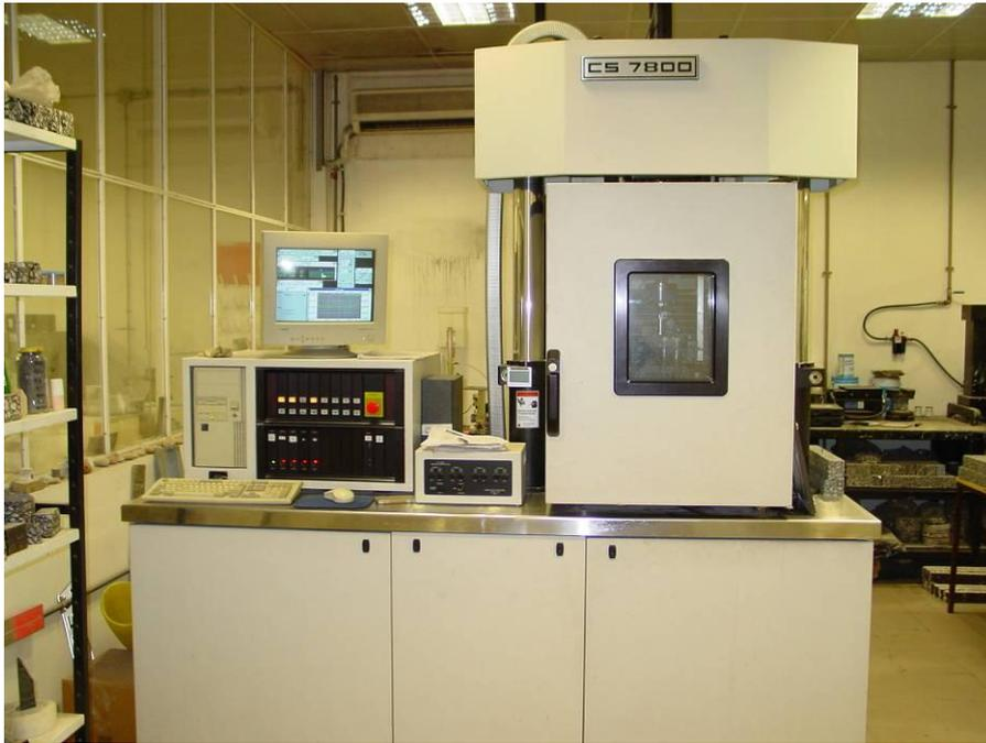
Figura 3.3 - Equipamento servo-hidráulico para realização de ensaios de fadiga
