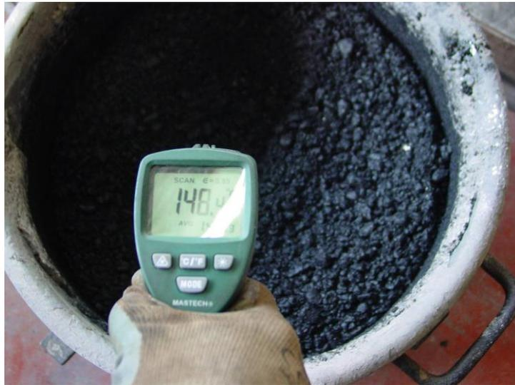
Figura 4.4 – Temperatura da mistura antes da compactação
