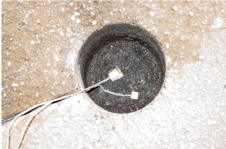
Figura 5.5 – Materiais piezoelétricos 1 e 3 na base do furo (10 cm de profundidade)
