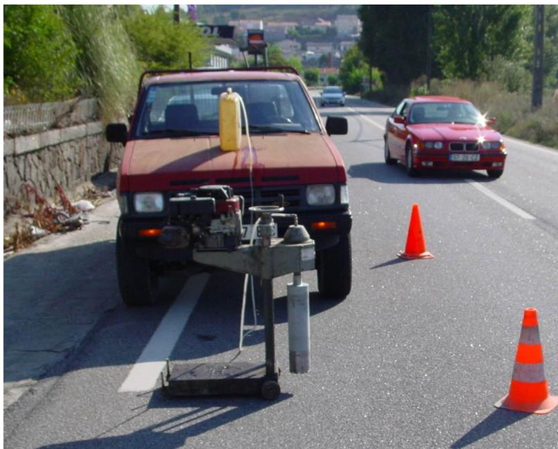
Figura 5.3 – Caroteadora, equipamento usado para extração de carotes do pavimento
