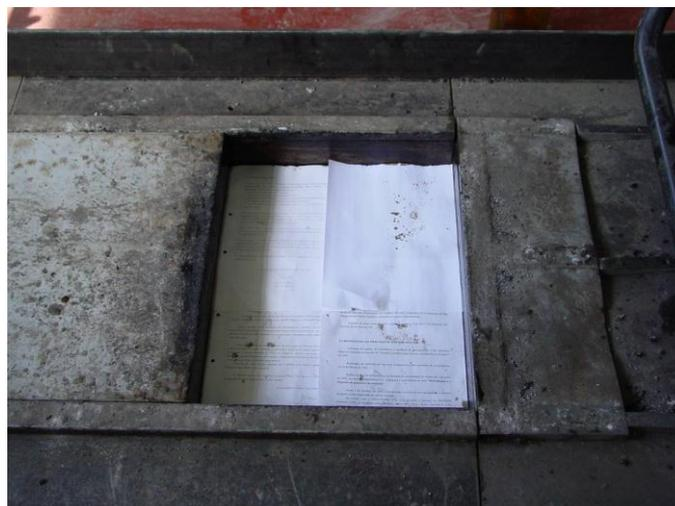
Figura 4.5 – Molde para compactação de lajes
