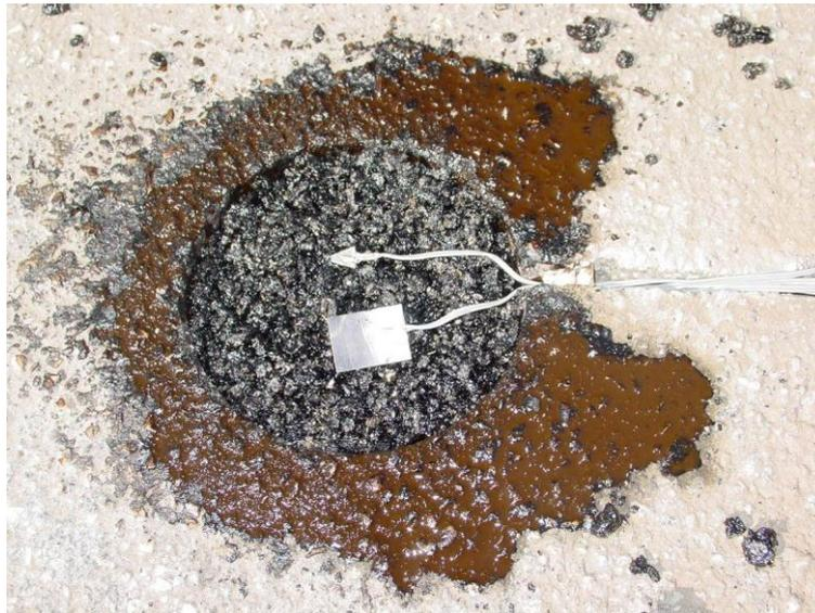
Figura 5.7 – Colocação dos materiais piezoelétricos 3 e 6 a 1cm de profundidade
