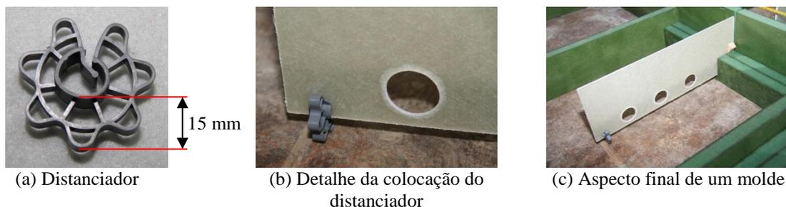
Figura 4.4 – Posicionamento dos conectores nos provetes de tipo *push-out*
