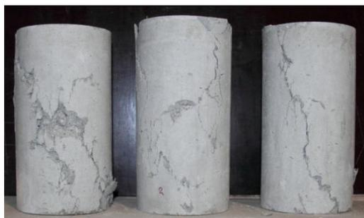
Figura 4.15 – Modos de rotura dos provetes BACRFA, *pull-out*
