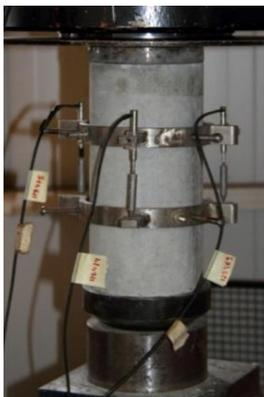
Figura 4.17 – Configuração do ensaio de determinação do módulo de elasticidade
