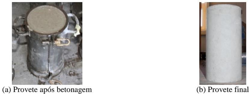
Figura 4.10 – Provete cilíndrico de caracterização de BAC
