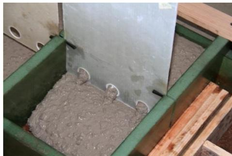
Figura 4.11 – Passagem do BAC através dos furos do conector
