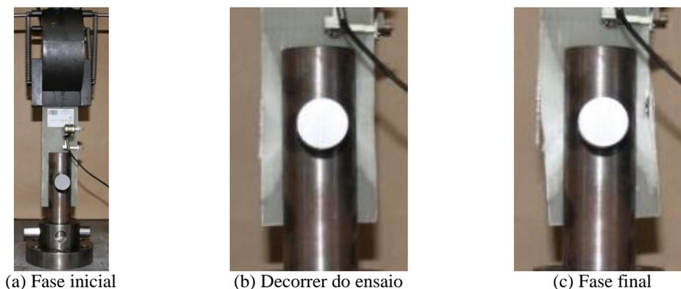
Figura 7.7 – Evolução de um provete de rasgamento lateral de manta QUASI
