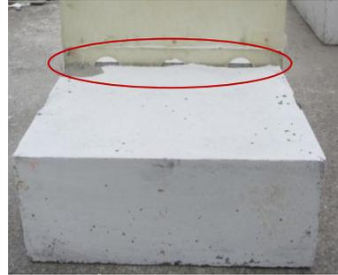
(a) Esquema da rotura da interface dos provetes CSM-L3C-BACRFA e BAC, e todos os provetes lisos
