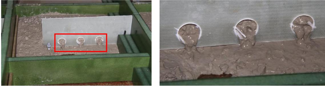
Figura 4.6 – Passagem do BACRFA pelas aberturas dos conectores *push-out*
