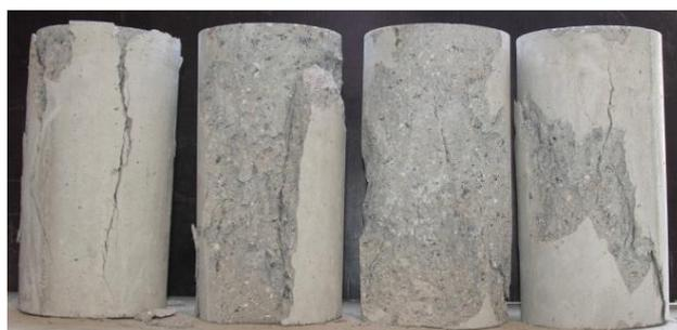
Figura 4.16 – Modos de rotura dos provetes BAC, *pull-out*
