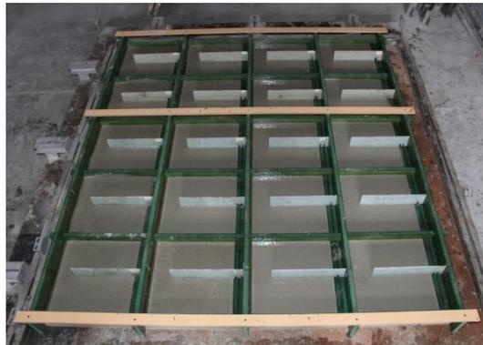
Figura 4.7 – Provetes de tipo *push-out* nos moldes após a betonagem
