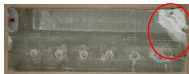
Figura 5.14 – Rotura por esmagamento na parte inferior do provete (Quasi-e5,0-Liso-SR-01 (direita))
