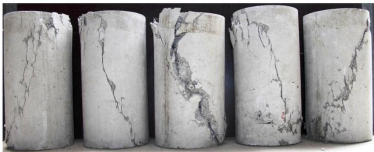
Figura 4.14 – Modos de rotura dos provetes BACRFA, *push-out*
