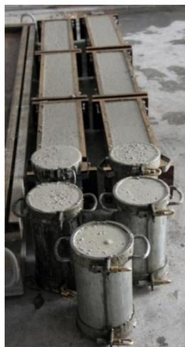
Figura 4.5 – Provetes de caracterização do BACRFA de *push-out* após betonagem
