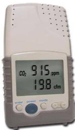
Figura 3.7 – Sensor de dióxido de carbono utilizado na monitorização da qualidade do ar (equipamento da marca Telaire, modelo 7001)
