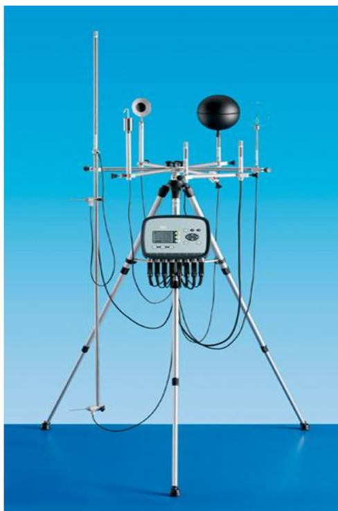
Figura 3.3 – Estação de conforto térmico (equipamento da marca Delta Ohm, modelo HD32.1 - Thermal Microclimate)
