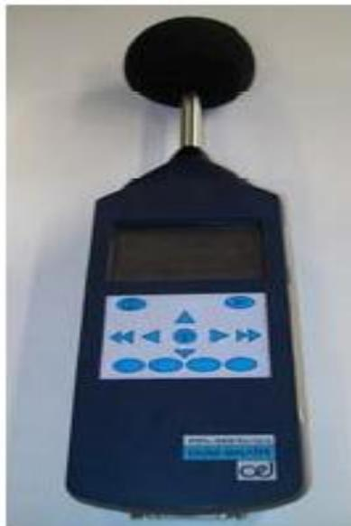
Figura 3.6 - Sonómetro utilizado na monitorização do ambiente acústico (equipamento da marca CEL, série 500)
