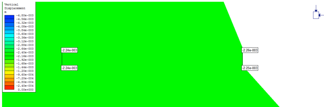
Figura 37 - Verificação dos deslocamentos verticais no suporte
