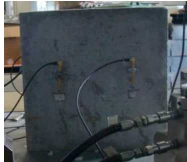
Figura 92 - Disposição da instrumentação na face posterior
