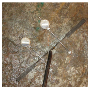
Figura 17 – Extensômetros aplicados na proximidade do entalhe (LNEC)
