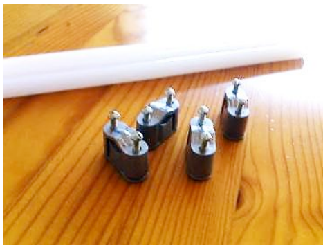
Figura 94 - Fixadores e cola dos LVDT
