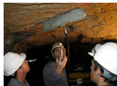
Figura 18 – Flat Jack aplicado no entalhe (LNEC)
