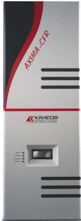
Figure 16 - MALDI-TOF apparatus being used at Micoteca da Universidade do Minho.
