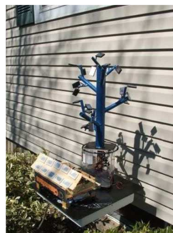
Figura 3.84 O protótipo em testes para coletar a radiação solar. Fonte: AIDAN, 2011.
