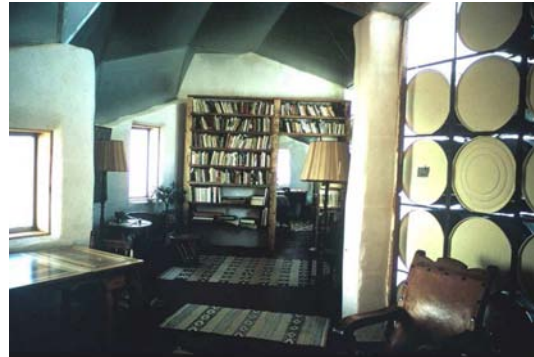
Figura 3.39 Vista do interior da Casa Corrale, à direita a parede de água feita com tambores. Fonte: BAINBRIDGE, 2005.
