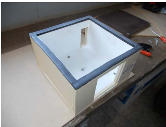
Figura 4.82 Detalhe da parte superior da maquete com as lâminas de borracha para vedação posicionadas.
