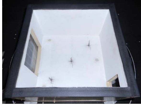
Figura 4.85 Sensores internos (P2, P3 e P4) posicionados na maquete.
