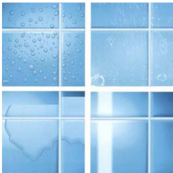
Figura 3.85 Exemplo de revestimento sem (superior) e com (inferior) cobertura de auto-limpeza.
