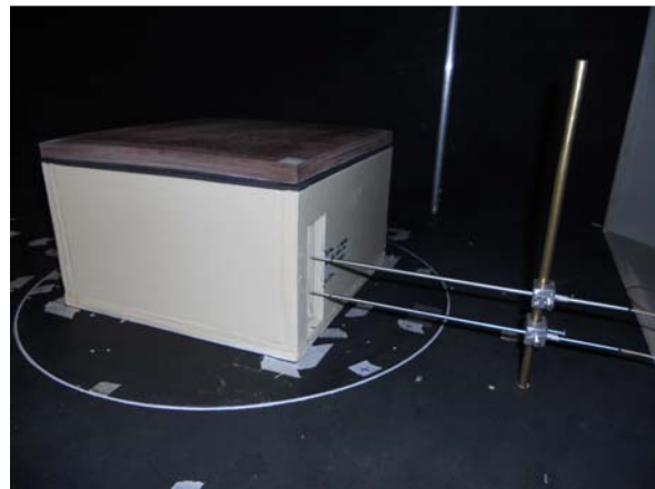
Figura 4.87 Hastes metálicas e sensores externos (P5 e P6) posicionados na saída de ar da maquete.
