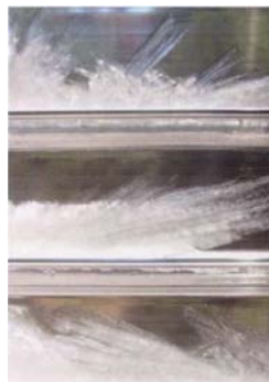
Figura 3.86 Detalhe de PCM's embutidos em vidro.
