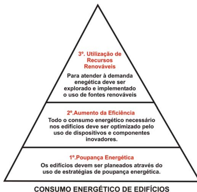
Figura 3.1 “ Trias Enegetica ” ilustrativa dos três passos que devem ser seguidos na busca pela eficiência energética dos edifícios.
