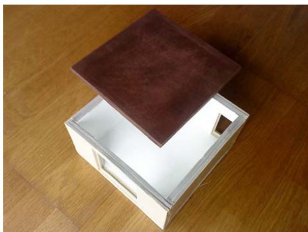
Figura 4.66 Detalhe da cobertura que foi deixada aberta para possibilitar a instalação de sensores e demais mecanismos necessários para execução do ensaio.
