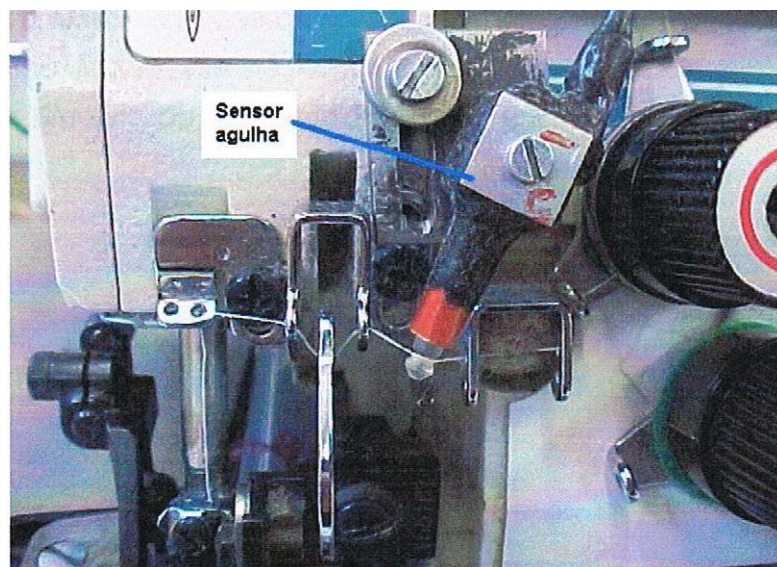
Figura 3-10 - Posicionamento do sensor extensómetro tipo strain gauge da linha da agulha (Carvalho M.,2003)
