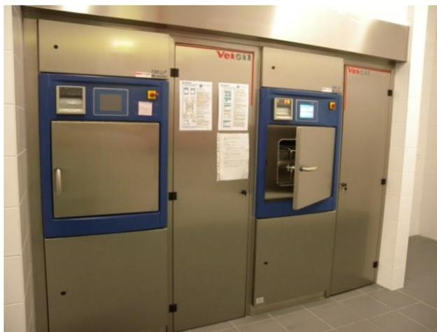
**Figura 37 - Autoclave a formaldeído**
