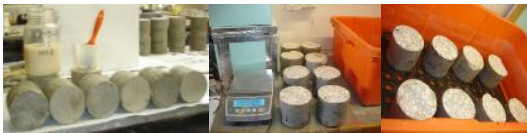
Figura 7. Ensaio de absorção de água por capilaridade à pressão atmosférica
