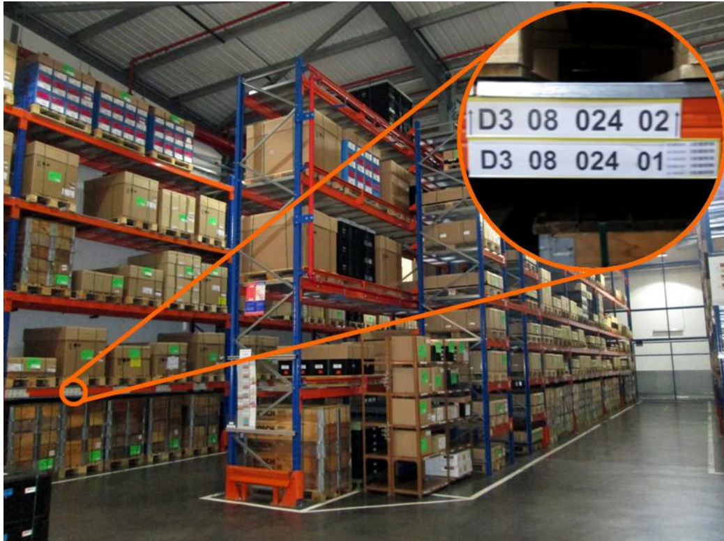
Figura 32. Sistema de codificação de localizações no armazém de produto acabado
