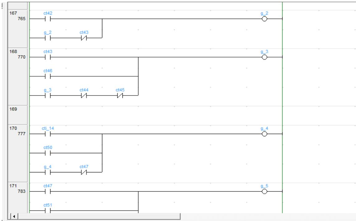
Figura 59 – Representação parcial das equações ladder dos modelos construídos.
