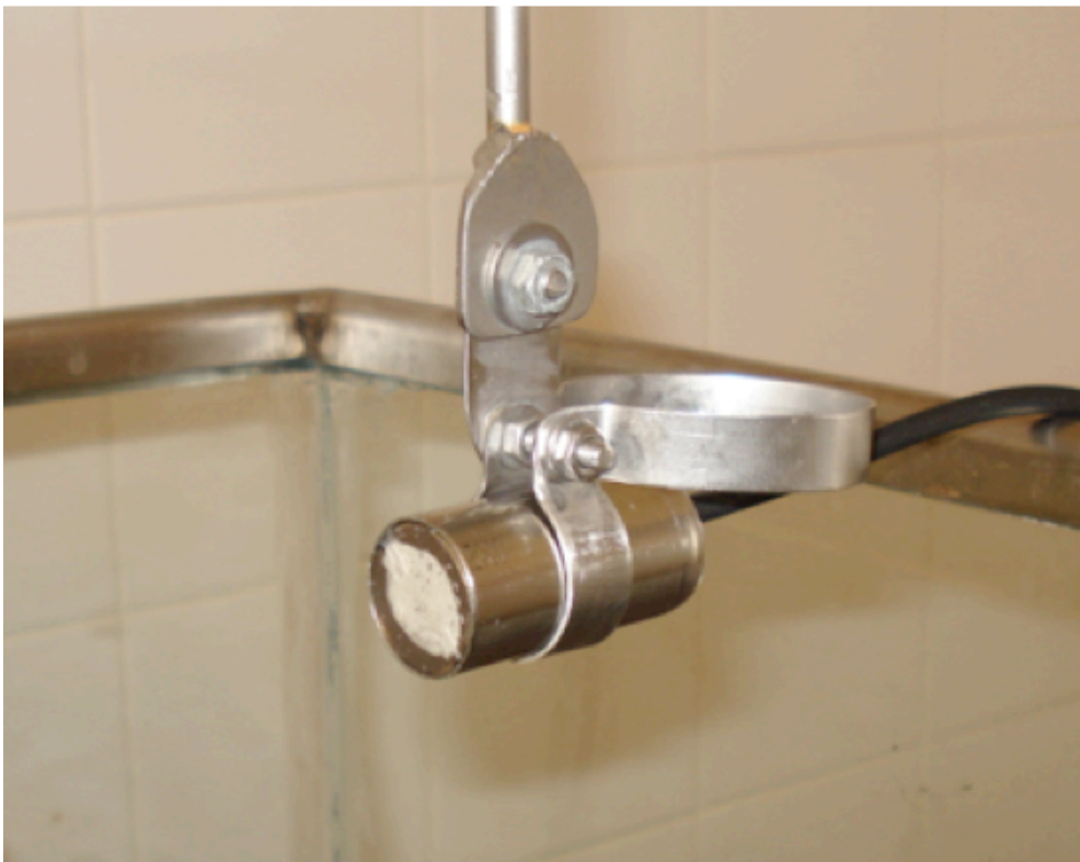
Figura 3.8 - Transdutor (Projeter) de ultrassons PVDF usado no sistema (Gonçalves, 2012)
