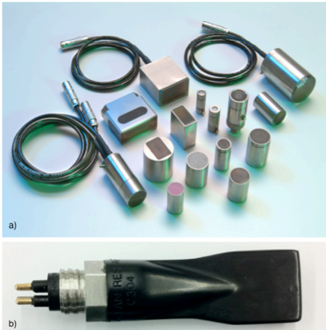
Figura 3.2 - Tipos de transdutores existentes a) projetores (emissores) b) hidrofones (recetor) (Gonçalves, 2012).
