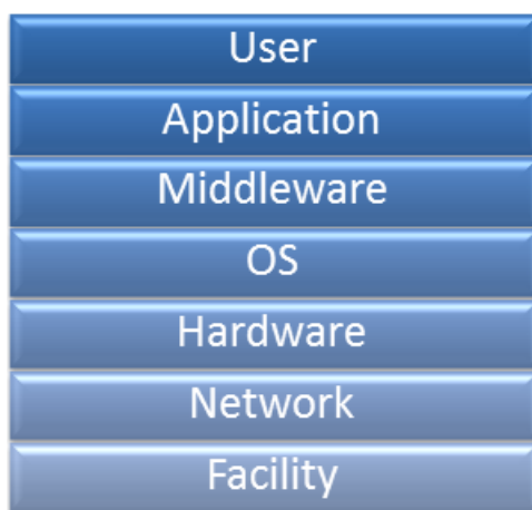
Figura 3.2: Modelo estratificado para a Segurança Cloud , segundo a CSA.
