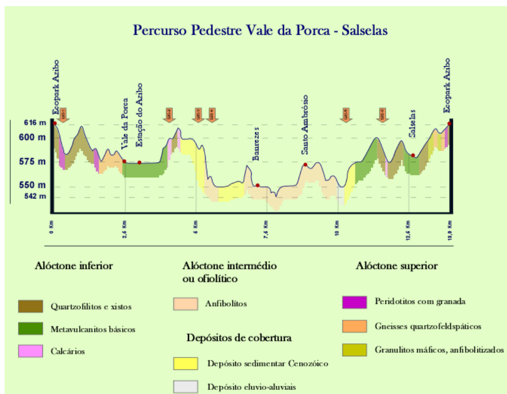
Figura 19: Perfil altimétrico e substrato geológico do percurso.
